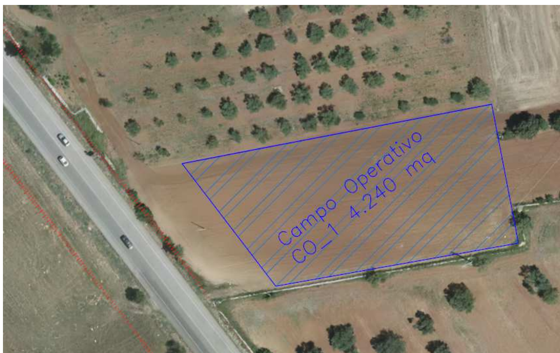
Figura 5-10: Superficie occupata dal Cantiere Operativo CO_1
