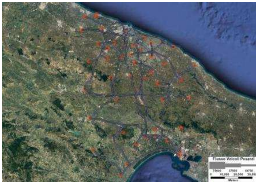
Figura 5.4: Mappa di assegnazione della rete di trasporto stradale nella simulazione dello Scenario Attuale – Mezzi Pesanti
