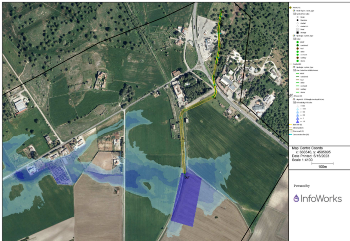
Figura 1-13: Mappa delle aree allagabili per T_R = 200 anni, post-operam da simulazione idraulica di progetto
