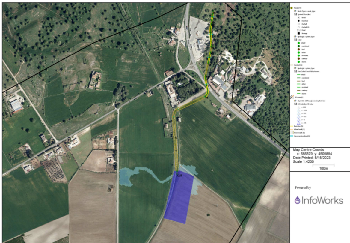
Figura 1-14: Mappa delle aree allagabili per T_R = 30 anni, post-operam da simulazione idraulica di progetto
