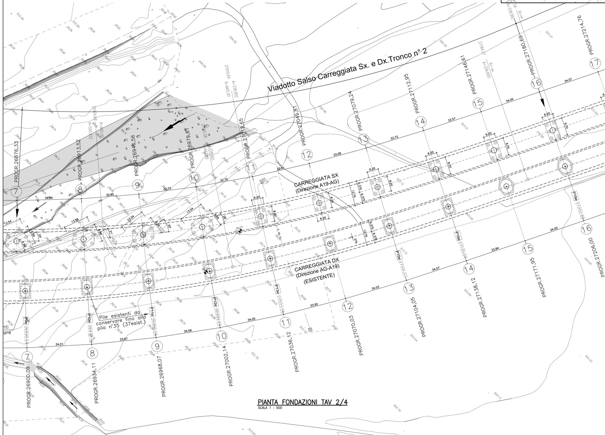
N.B. : GLI INTERASSI PILE SONO MISURATI SULL'ASSE IMPALCATO
