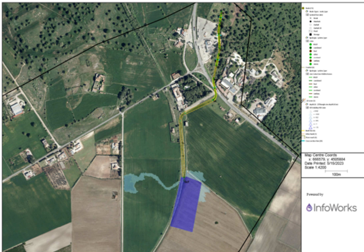
Figura 7-13: Mappa delle aree allagabili per T_R = 30 anni, post-operam da simulazione idraulica di progetto
