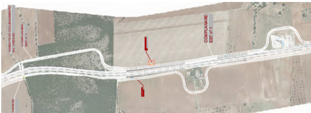
Figura 6-8. Soluzione prescelta da PD da Km 1+800 a Km 3+300 ove si evince lo spostamento del Cavalcavia e del tratto di complanare ovest dal KM 1+800 al Km 2+320 per interferenza area a bosco
