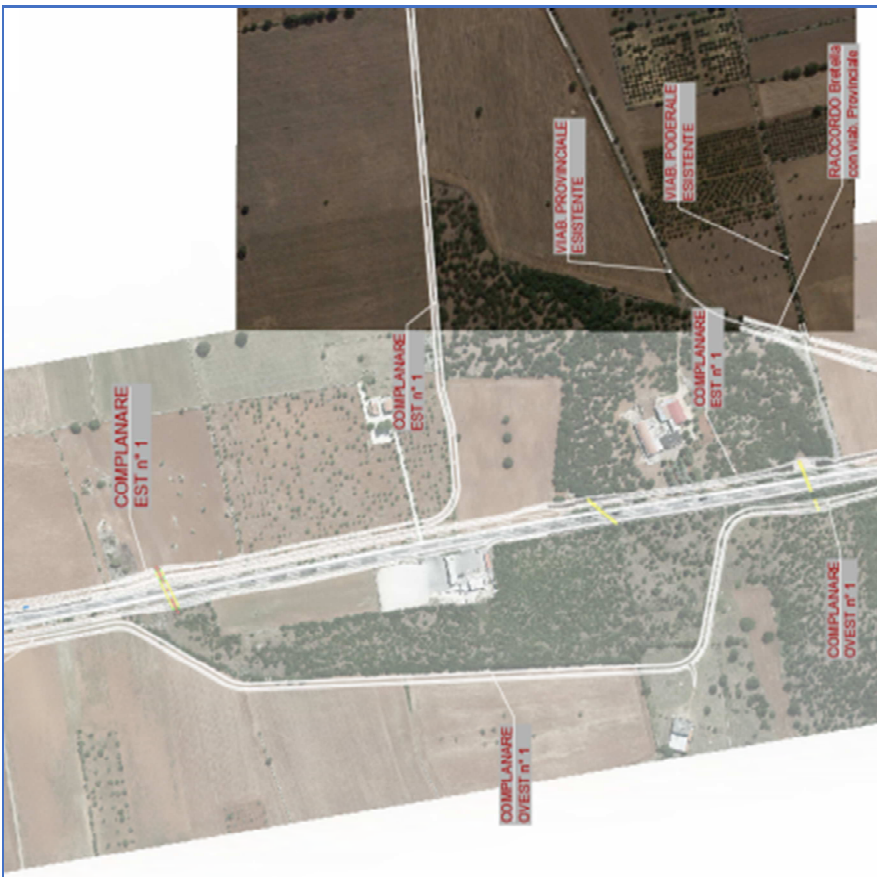
Figura 6-10. Soluzione prescelta da PD da Km 3+600 a Km 3+400 ove si evince lo spostamento del tratto di complanare ovest all'esterno dell'area a bosco e della complanare est per raccordo bretella con SP
