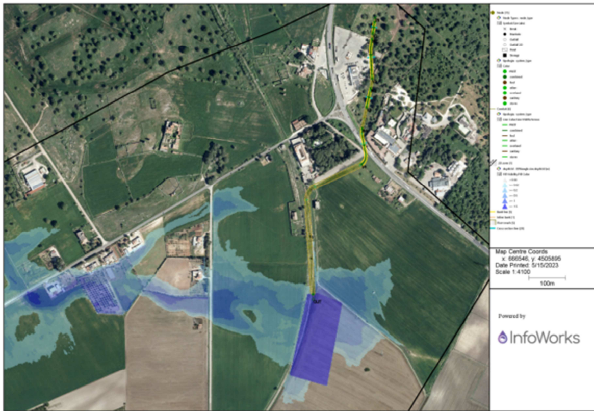
Figura 7-12: Mappa delle aree allagabili per T_R = 200 anni, post-operam da simulazione idraulica di progetto
