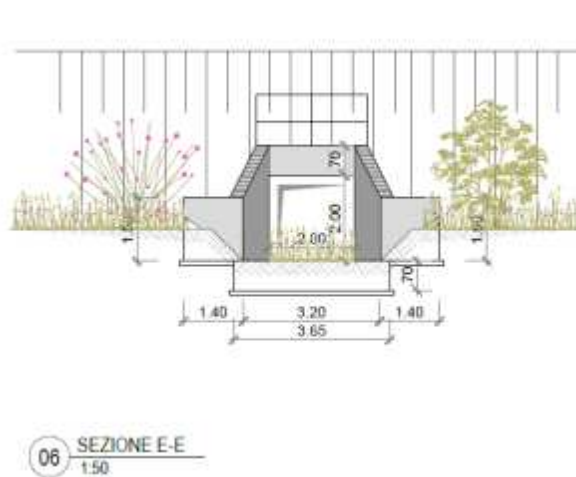
Figura 7.9. Prospetto e sistemazione attraversamenti faunistici
