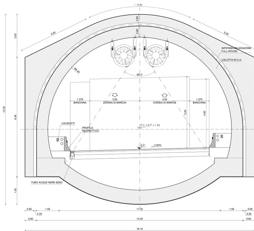
SEZIONE TIPOLOGICA DIMA D'ATTACCO E SOTTODIMA
