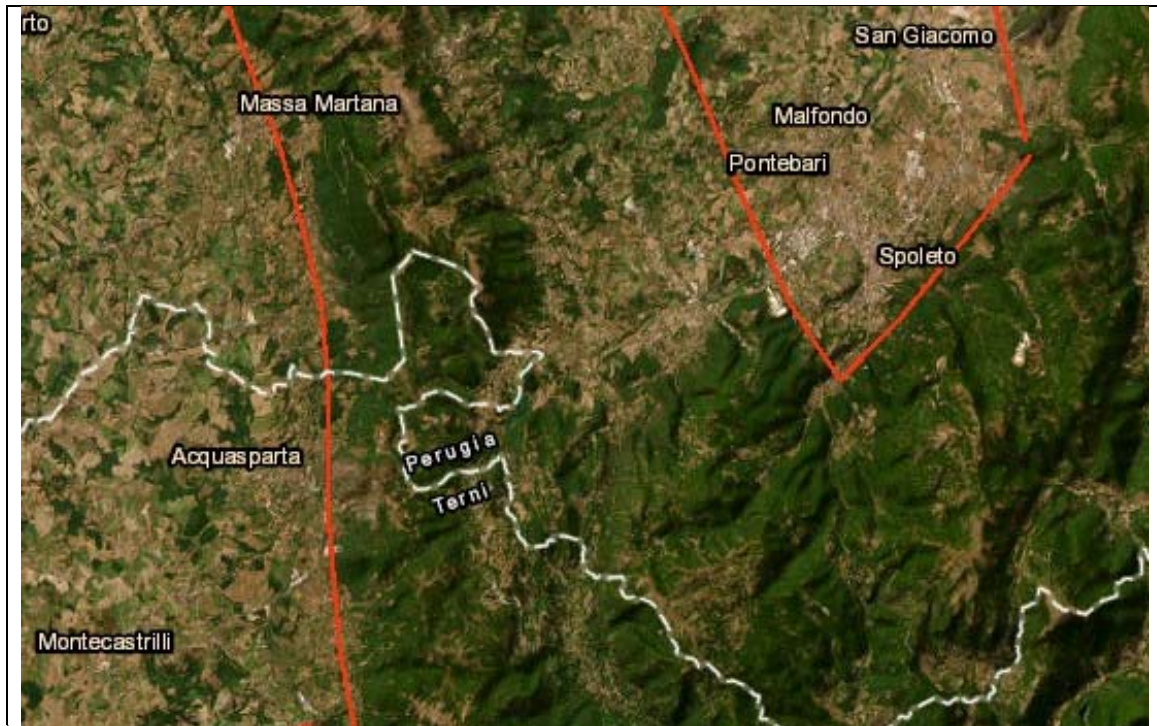
Figura 26 - Individuazione delle faglie capaci: Martani Mts Fault, Spoleto valley (fonte: progetto ITHACA- Servizio Geologico Nazionale, ISPRA, 2011).
