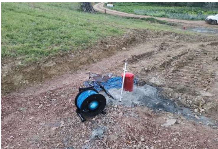
Chiusino fuori terra con sonda inclinometrica
