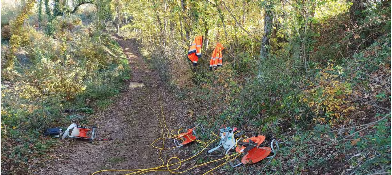
Fig. 10.6 – Foto del profilo ERT5 di tomografia elettrica di resistività.
