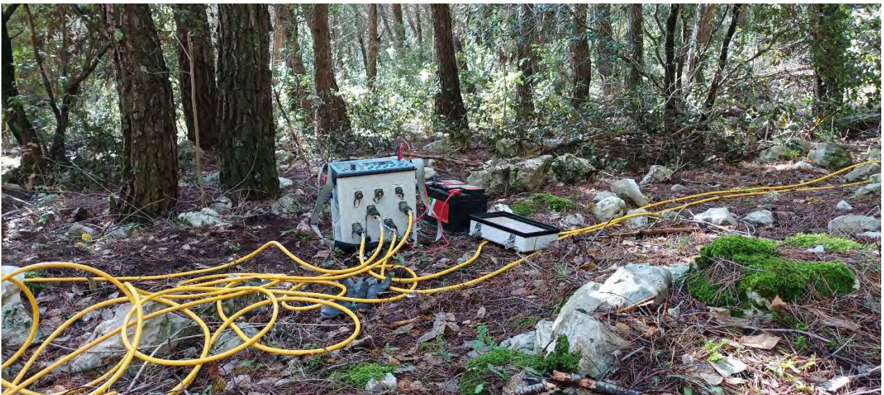
Fig. 10.7 – Foto del profilo ERT6 di tomografia elettrica di resistività.
