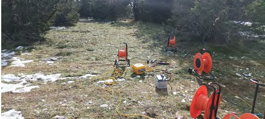
Foto 1 – Prospezioni sismiche a riflessione. Postazione di acquisizione dati.
