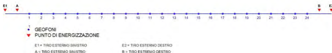
Figura 14.2 Indagine MASW. Disposizione siti di energizzazione.
