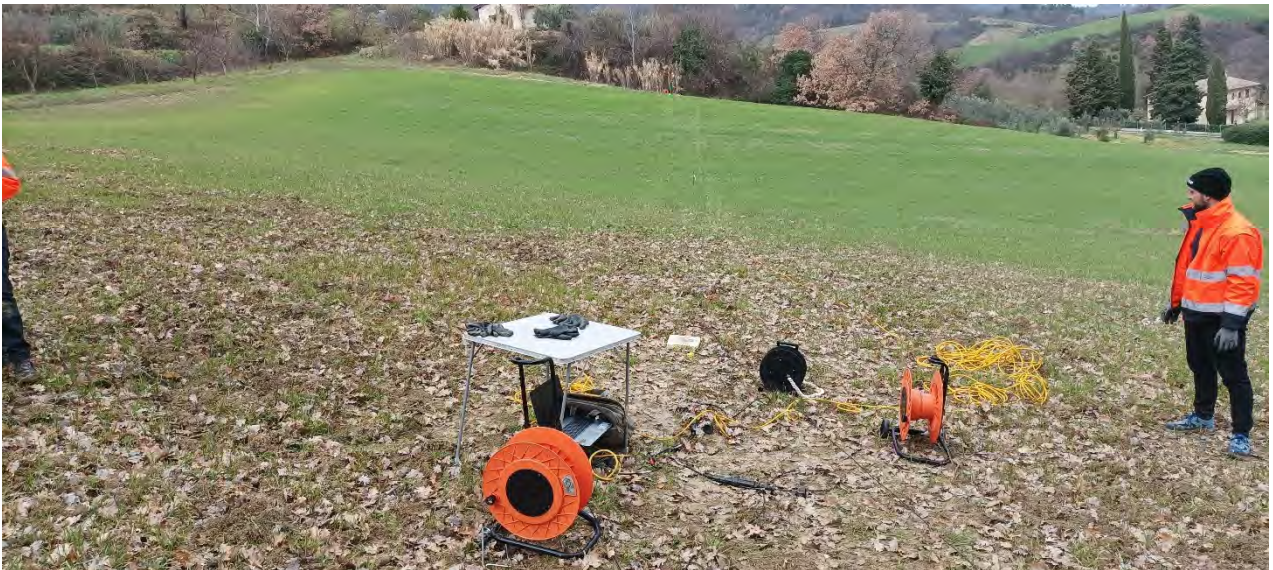
Fig. 11.3 – Foto del profilo SRT3 di tomografia sismica.
