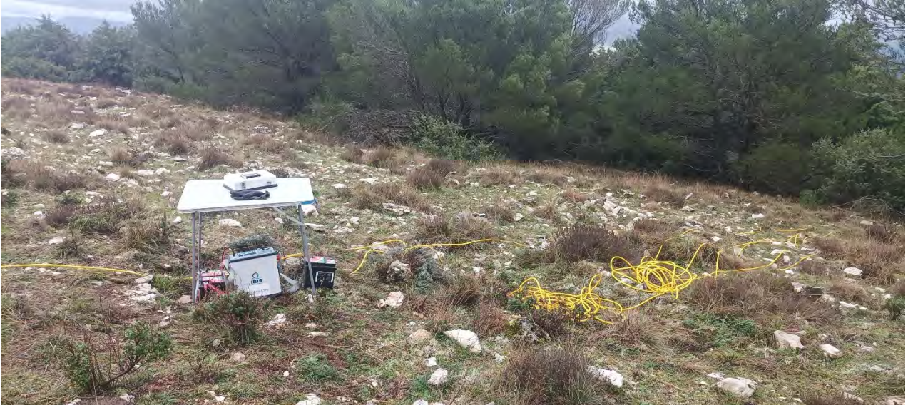
Fig. 10.2 – Foto del profilo ERT1 di tomografia elettrica di resistività.
