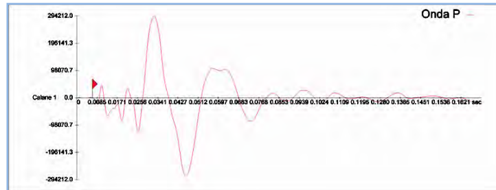
Fig. 13.2 - Esempio di onda P e di lettura del primo tempo di arrivo.
