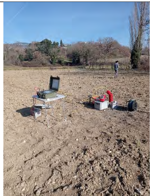
Foto 4 – Prospezioni sismica in foro Down-Hole S11-DH.
