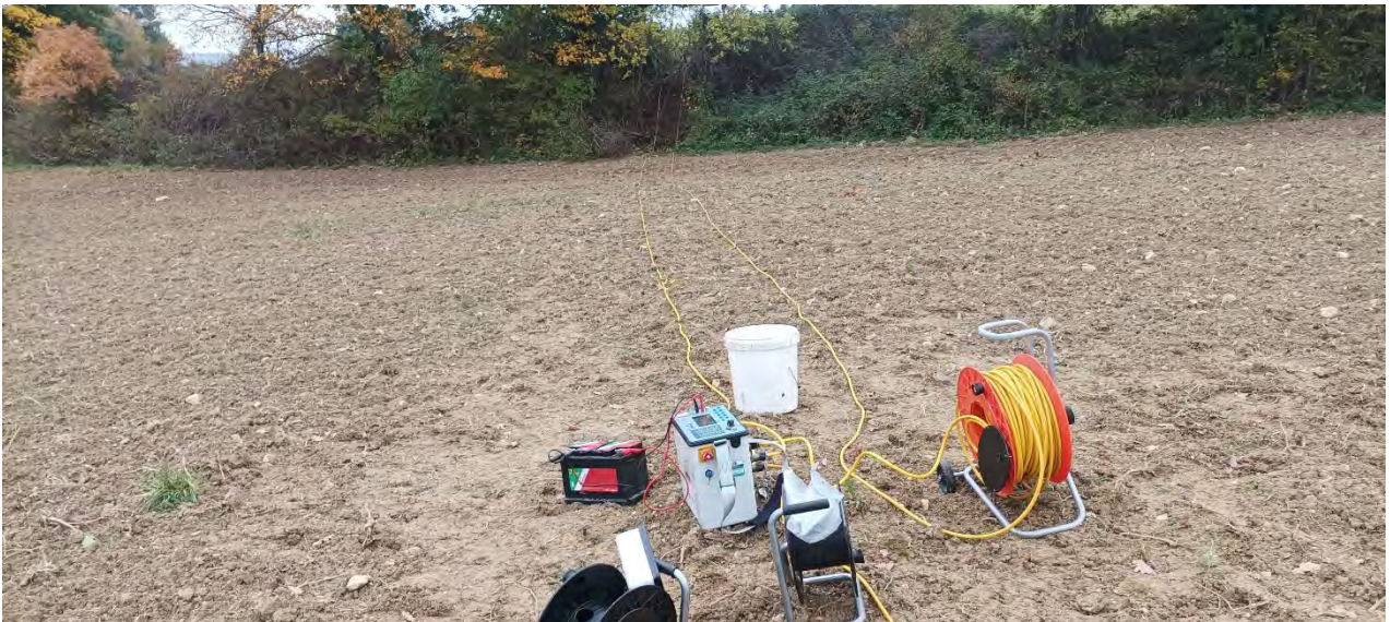
Fig. 10.4 – Foto del profilo ERT3 di tomografia elettrica di resistività.
