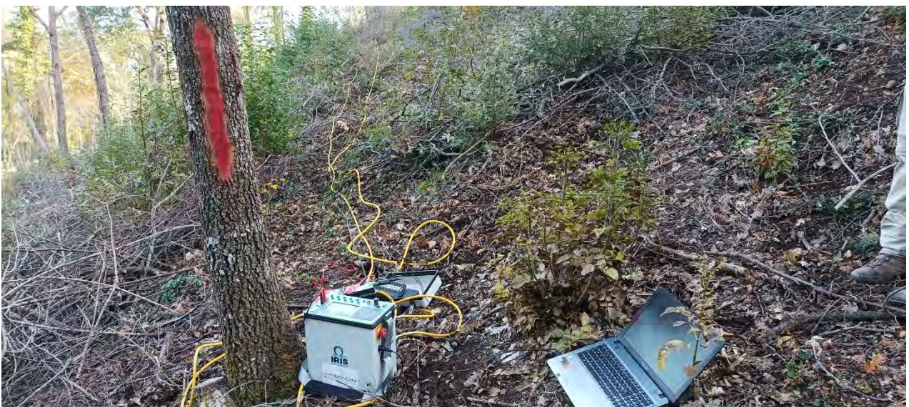
Fig. 10.5 – Foto del profilo ERT4 di tomografia elettrica di resistività.
