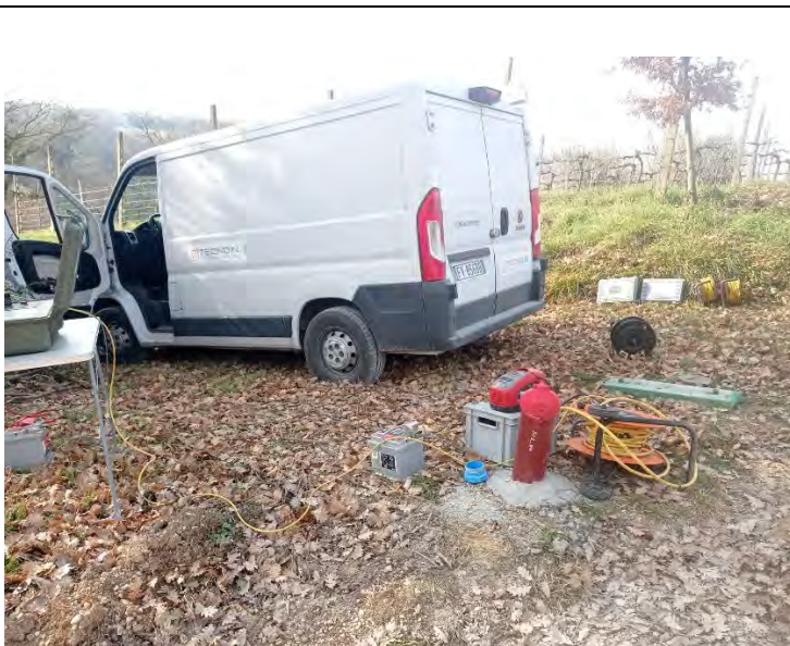
Foto 3 – Prospezioni sismica in foro Down-Hole S01-DH.
