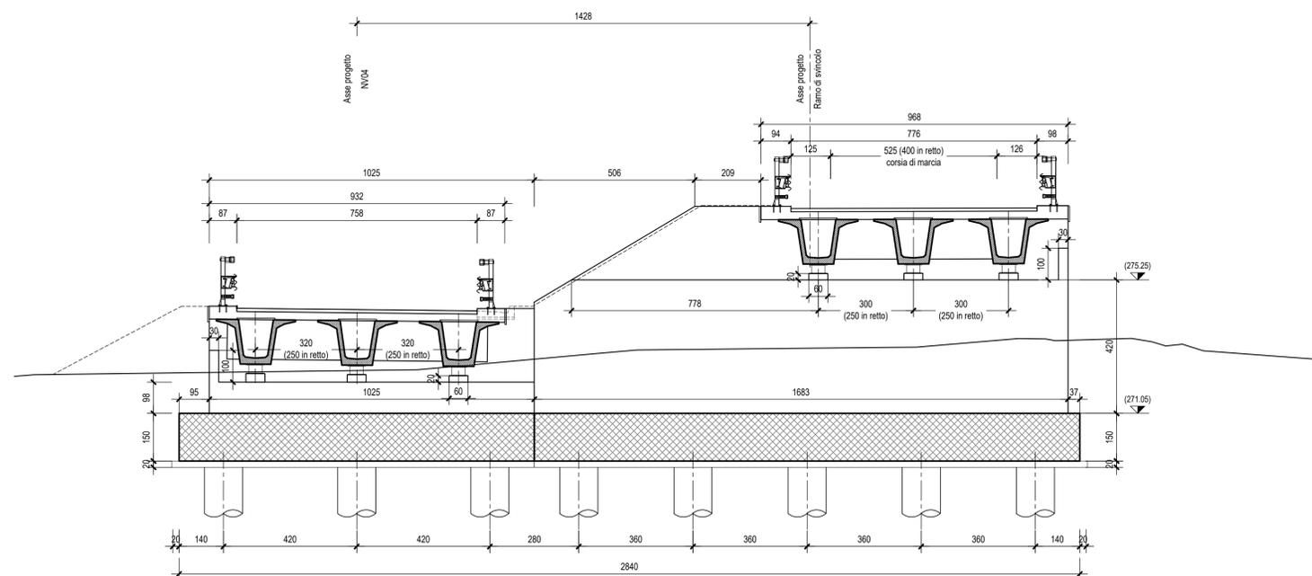
SEZIONE SPALLA S2-Scala 1:100
