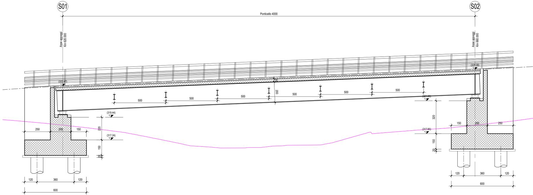
SEZIONE TIPO IN ASSE APPOGGIO-Scala 1:50
