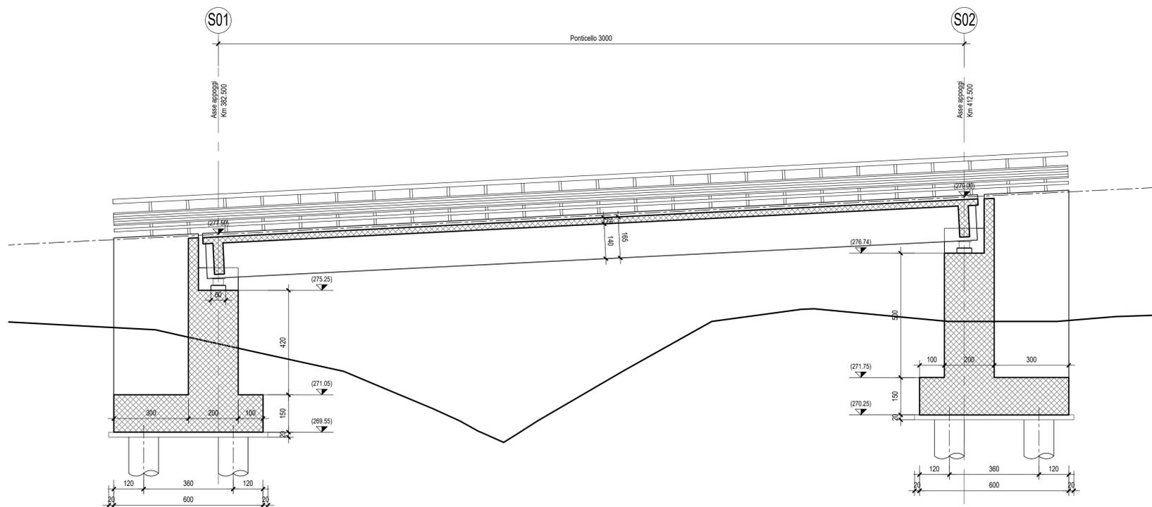
SEZIONE TIPO IN ASSE APPOGGIO SPALLA S1-Scala 1:50
