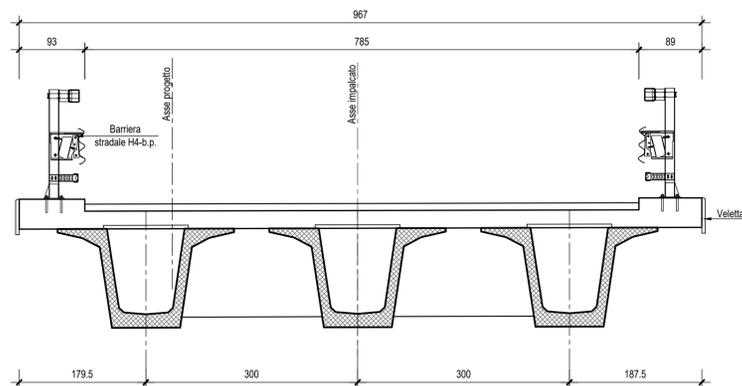
SEZIONE TIPO IN ASSE APPOGGIO SPALLA S2-Scala 1:50
