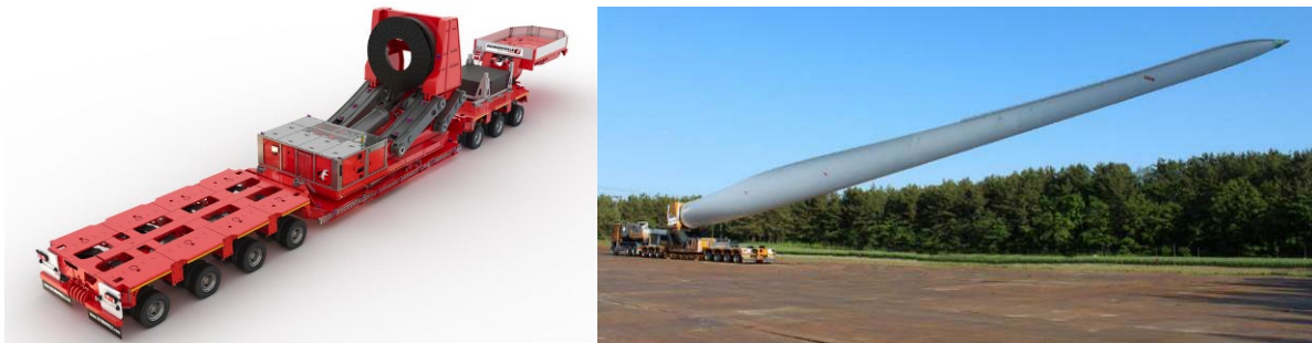
Figura 1: Blade-lifter utilizzato per ridurre gli spazi liberi e di manovra necessari per il trasporto dei componenti dell'aerogeneratore.
