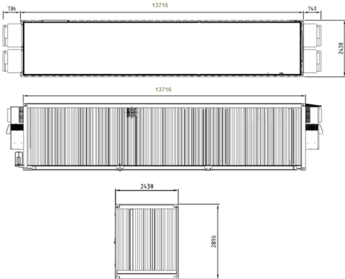
Figura 6 – Modulo container batterie.
