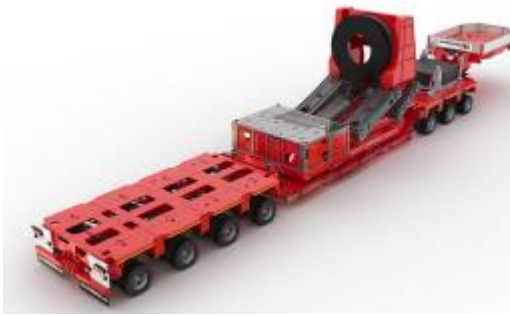
BLADE - LIFTER UTILIZZATO PER RIDURRE GLI SPAZI LIBERI E DI MANOVRA NECESSARI PER IL TRASPORTO DEI COMPONENTI DELL'AEROGENERATORE
