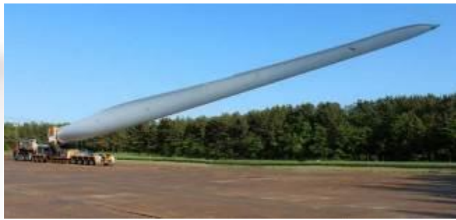
BLADE - LIFTER UTILIZZATO PER RIDURRE GLI SPAZI LIBERI E DI MANOVRA NECESSARI PER IL TRASPORTO DEI COMPONENTI DELL'AEROGENERATORE
