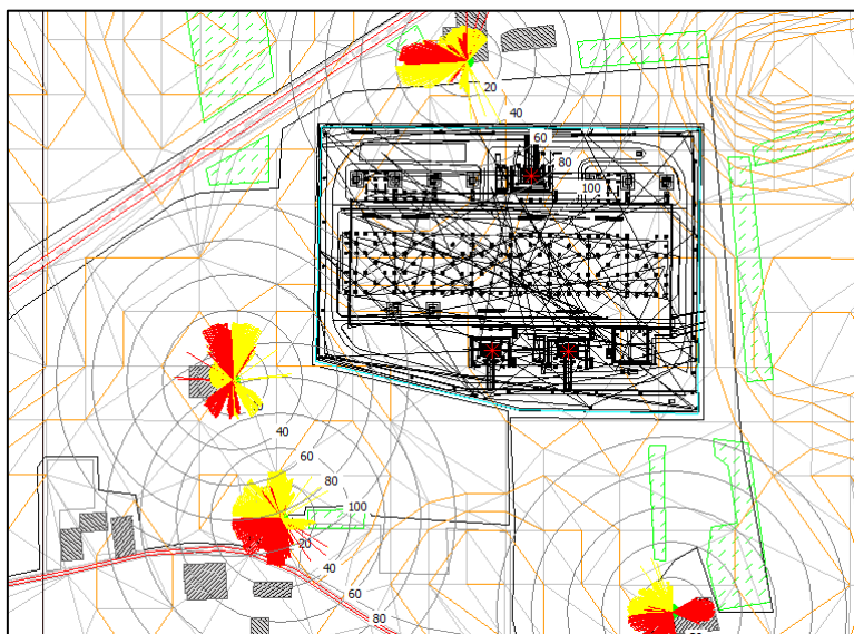
Figura 5: Specifica dell'applicazione della tecnica di calcolo a tracciamento di raggi (ray-tracing).
