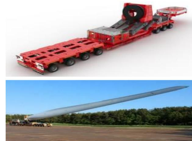
Figura 5.3: Blade-lifter utilizzato per ridurre gli spazi liberi e di manovra necessari per il trasporto dei componenti dell'aerogeneratore
