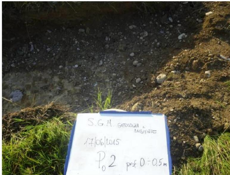
**Figura 8: Immagine fotografica del pozzetto Po2**
