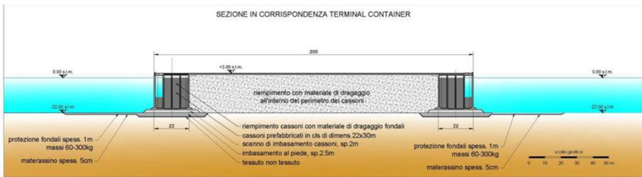
Figura 3.10: Sezione Area Terminal Container
