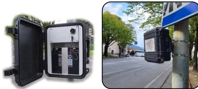
Figura 6-1 Esempio di posizionamento strumentazione contrattraffico
