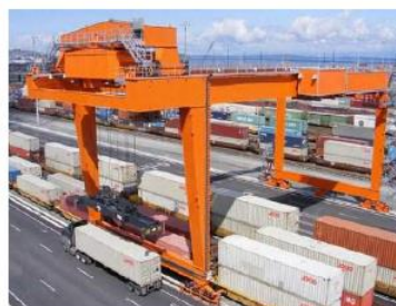
Le immagini riportano un esempio di gru a portale di tipo RMG.
