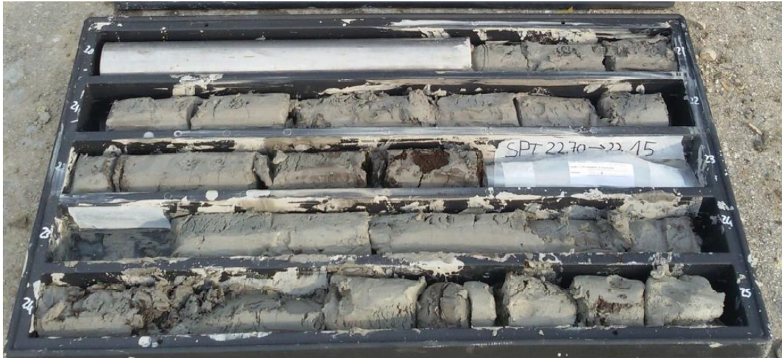
Figura 32: cassetta catalogatrice da 20 a 25 m del sondaggio SP2: si evidenzia la presenza prevalente di terreni fini argilloso-limosi con intercalazione di sabbia da -22.6 a -23.2 m
