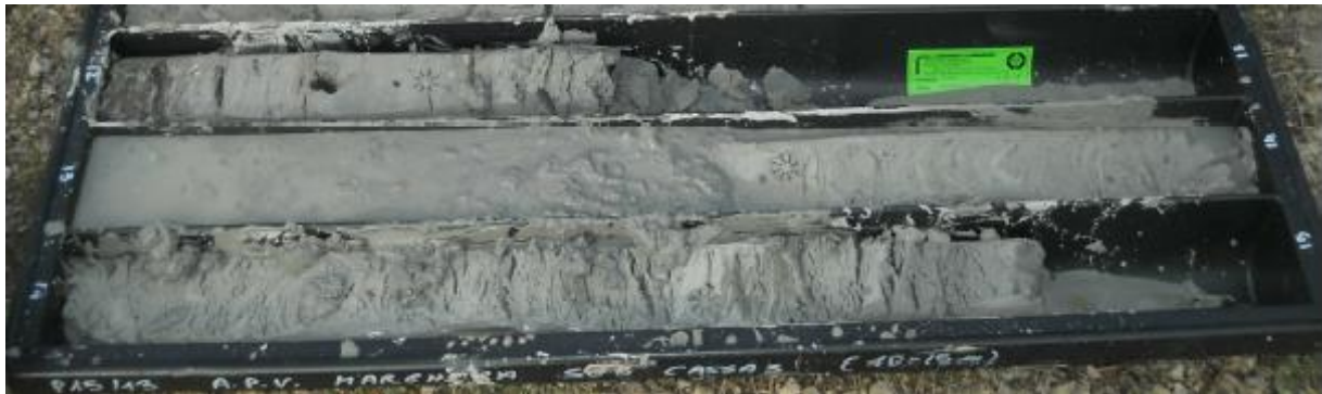
Figura 30: cassetta catalogatrice da 10 a 15 m del sondaggio SG5: visibile la presenza di sabbia fine limosa (-12.5/-13.6 m) alternata a livelli limosi e argilloso-limosi inferiormente
