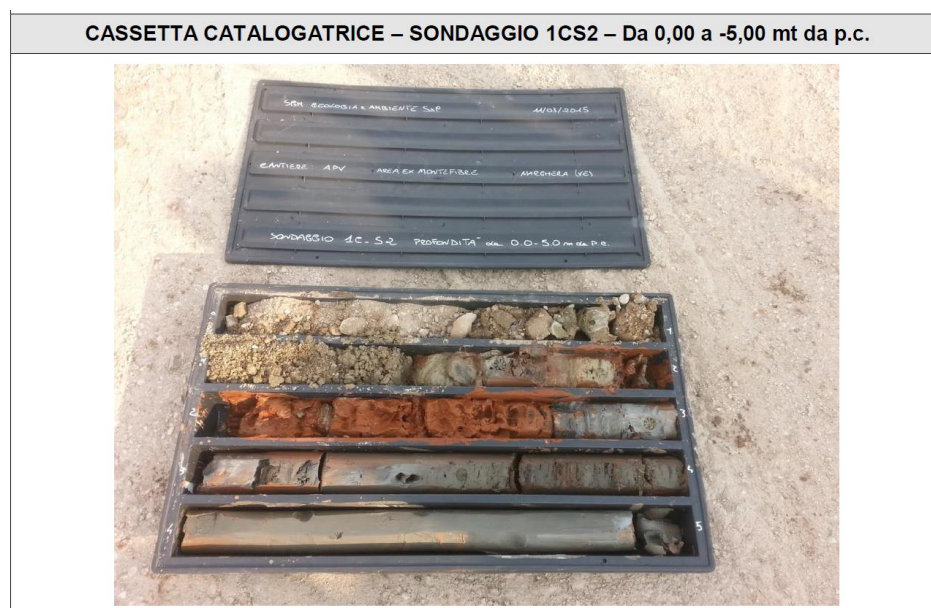
Figura 27: cassetta catalogatrice dei primi 5 m del sondaggio 1C-S2. È visibile 2 m di strato di riporto e 0.7 m di spessore di riporto contenente fanghi bauxitici dal tipico colore marrone –rosso
