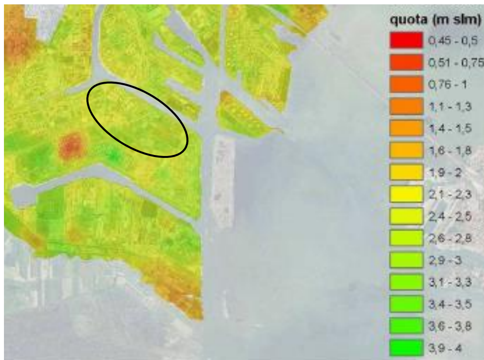
Figura 15: Microrilievo a laser LIDAR (Light Detection And Ranging) dell'area di Porto Marghera (fonte “Indagine idrogeologica sull'area di Porto Marghera – seconda fase – 2009”),
