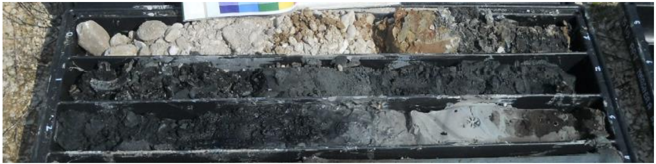
Figura 26: cassetta catalogatrice dei primi 5 m del sondaggio SG5: visibile 2.6 m di strato di riporto, di natura grossolana in superficie e più fine alla base
