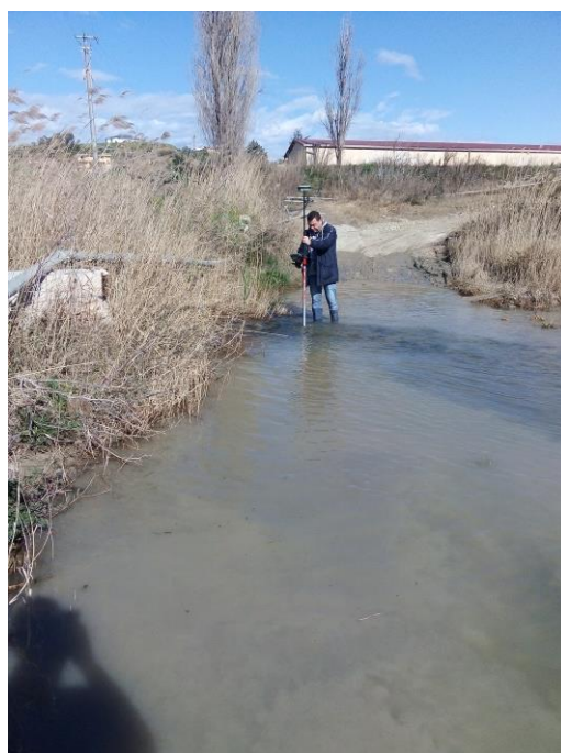
Foto 3: Rilievo topografico alveo torrente Passovecchio.
