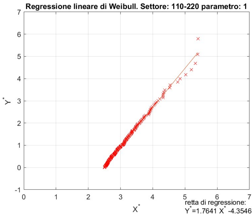
Figura 25 - Regressione lineare per la stima dei parametri delle distribuzioni di Weibull per il settore 110-220°N.
