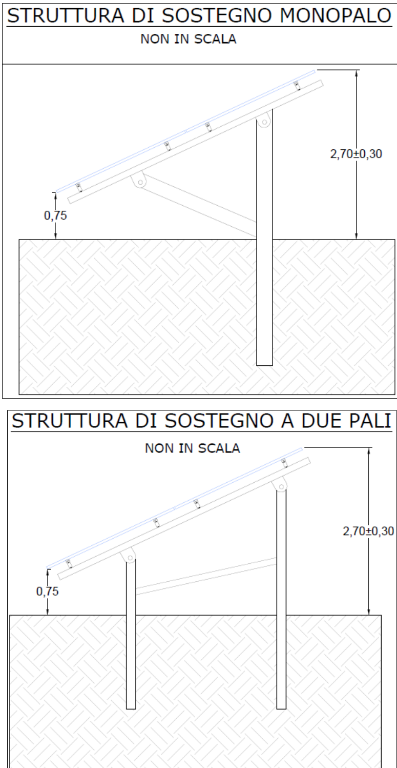
Fig. 3 – Particolari delle strutture di sostegno dei pannelli fotovoltaici
