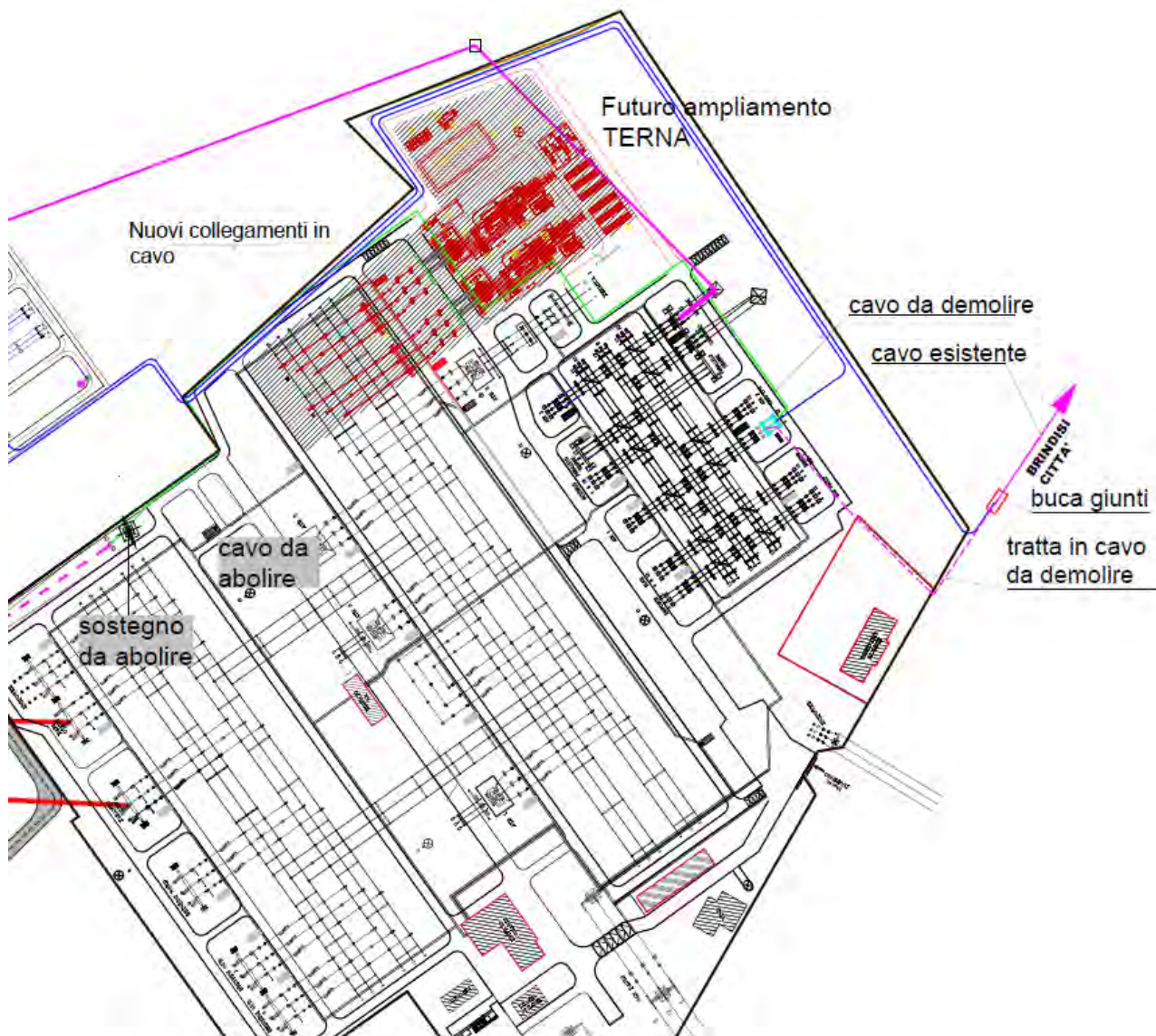
Figura 4-15 - Ampliamento Stazione Elettrica Terna 380/150 kV "Brindisi Pignicelle"
