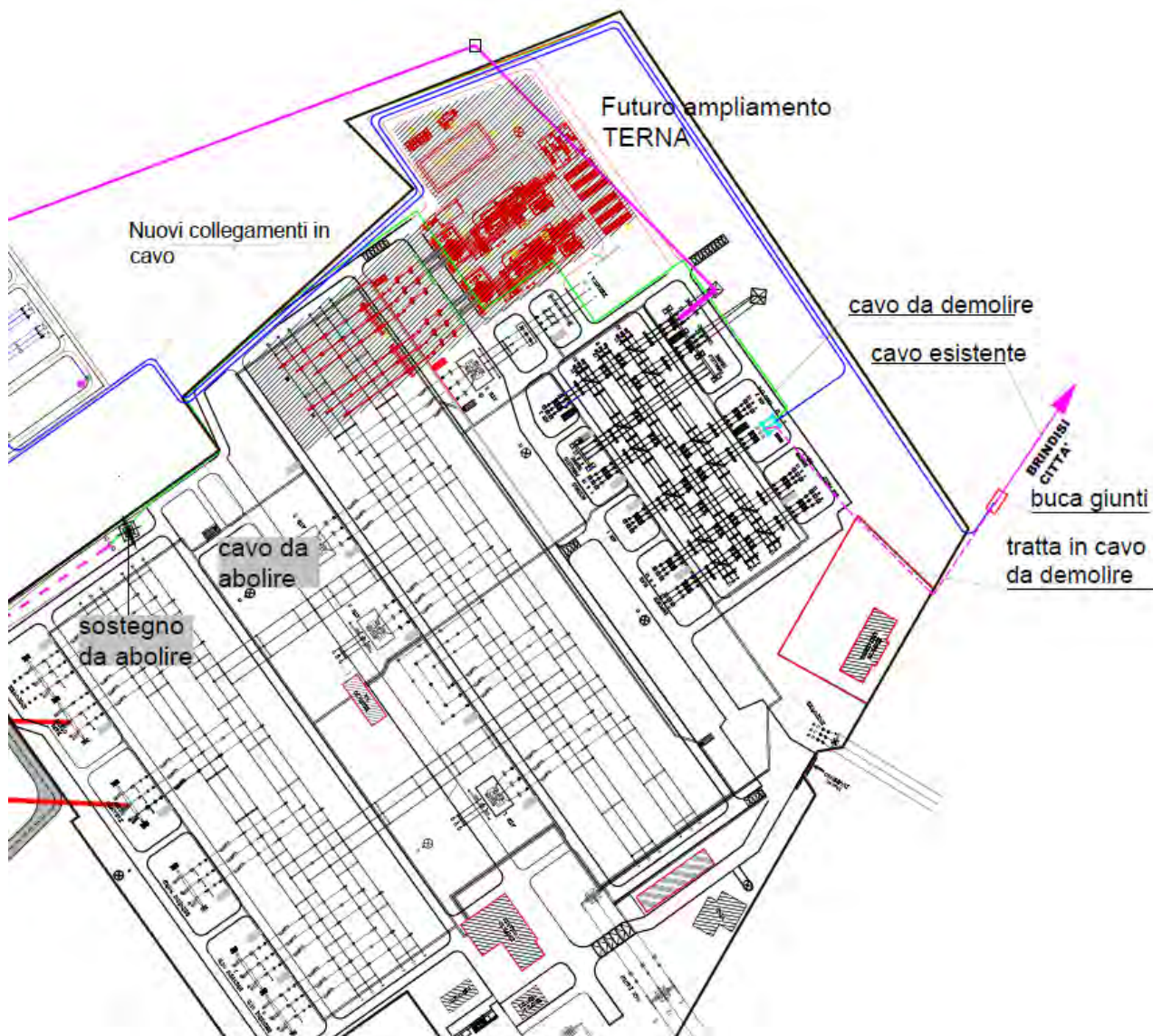
Figura 3-14 - Ampliamento Stazione Elettrica Terna 380/150 kV "Brindisi Pignicelle"
