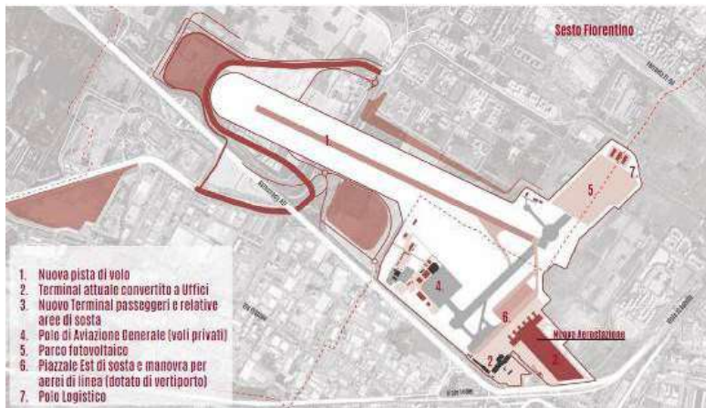
Immagine finale al 2035. In tratto rosso i soli interventi di nuova realizzazione, in grigio i comparti esistenti
