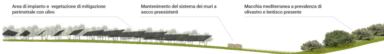
FIGURA 96 - SEZIONE PAESAGGISTICA TIPOLOGICA DELL'IMPIANTO
