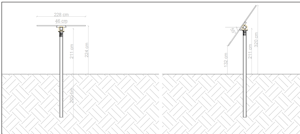
FIGURA 11 – TRACKER TIPO AD ASSE VARIABILE
