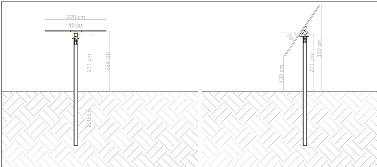
FIGURA 2: SCHEMA TIPO TRACKER AD ASSE VARIABILE
