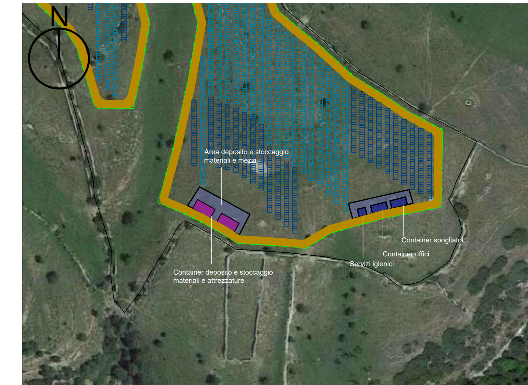
Particolare 3 aree cantiere - Scala 1:1000
