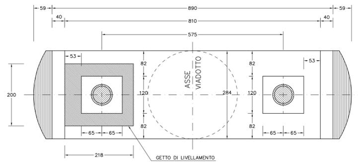
PIANTA PULVINO PILA N°16 SCALA 1:50
