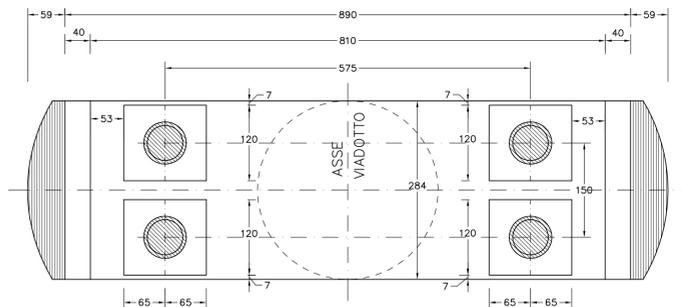
PIANTA PULVINO PILE N° 17÷20 SCALA 1:50
