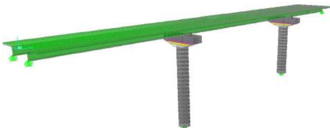
Modello agli elementi finiti per l' Analisi Sismica del tratto "A"
