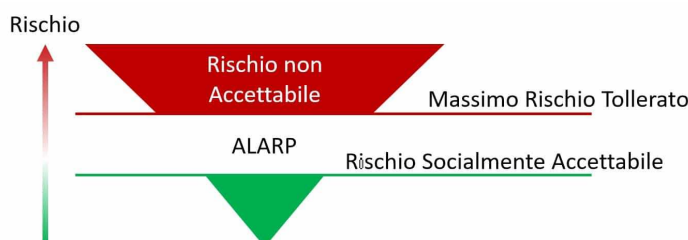
Figura 34. Schema illustrativo del principio ALARP.
