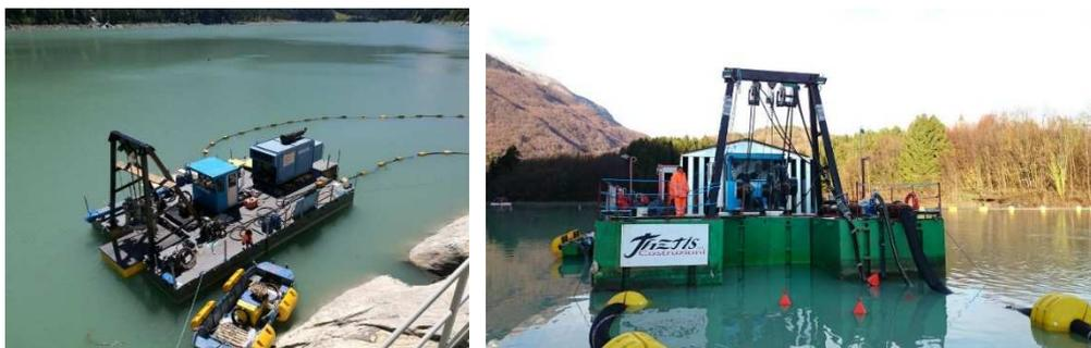
**Figura 18. Esempi di attrezzature installate su pontoni mobili e galleggianti.**
