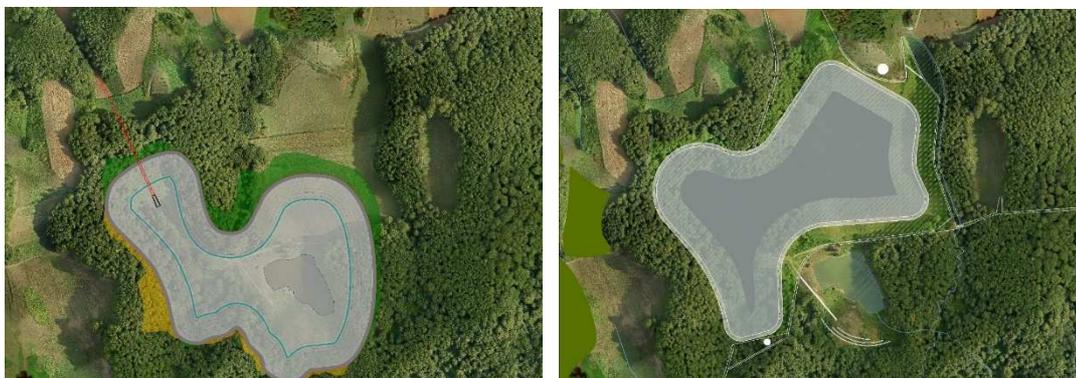
**Figura 29.** A destra la vecchia localizzazione dell'invaso di monte con la completa sommersione dell'esistente lago della Moretta. A sinistra la variante portata a progetto con la salvaguardia dello specchio d'acqua esistente ed una sensibile riduzione della pressione di boschi.
