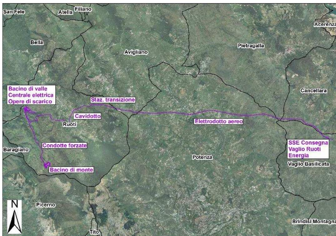
Figura 1. Planimetria su ortofoto delle componenti dell'opera in progetto.
