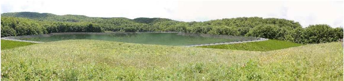
**Figura 60.** Rendering dello stato di progetto del bacino di monte. Si notano le arginature dell'invaso realizzate con pendenze dolci e rinverdite.
