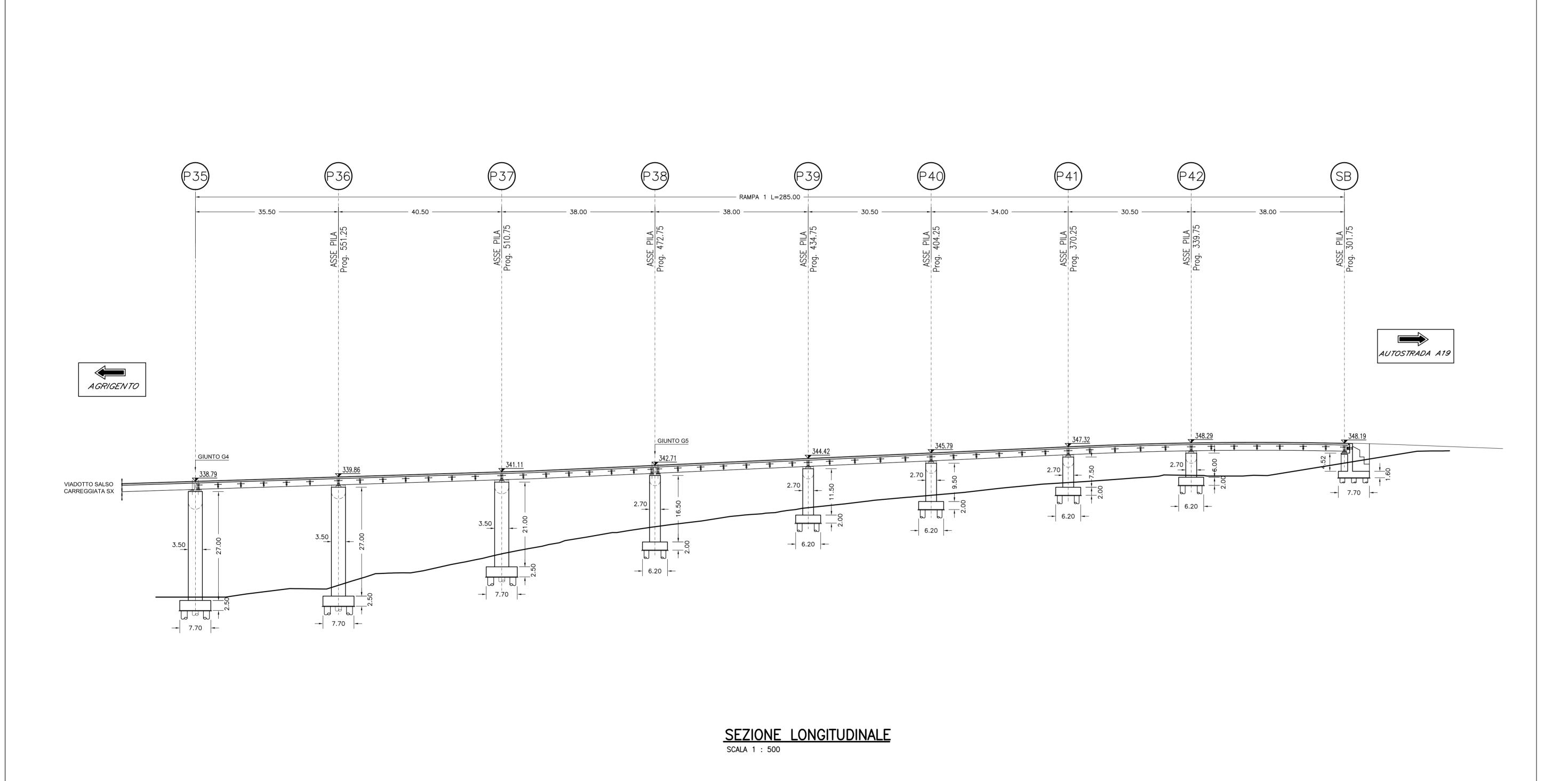
N.B.: GLI INTERASSI PILE SONO MISURATI SULL'ASSE IMPALCATO LE PROGRESSIVE SI RIFERISCONO ALL'ASSE TRACCIAMENTO (ASSE Q.P.)
