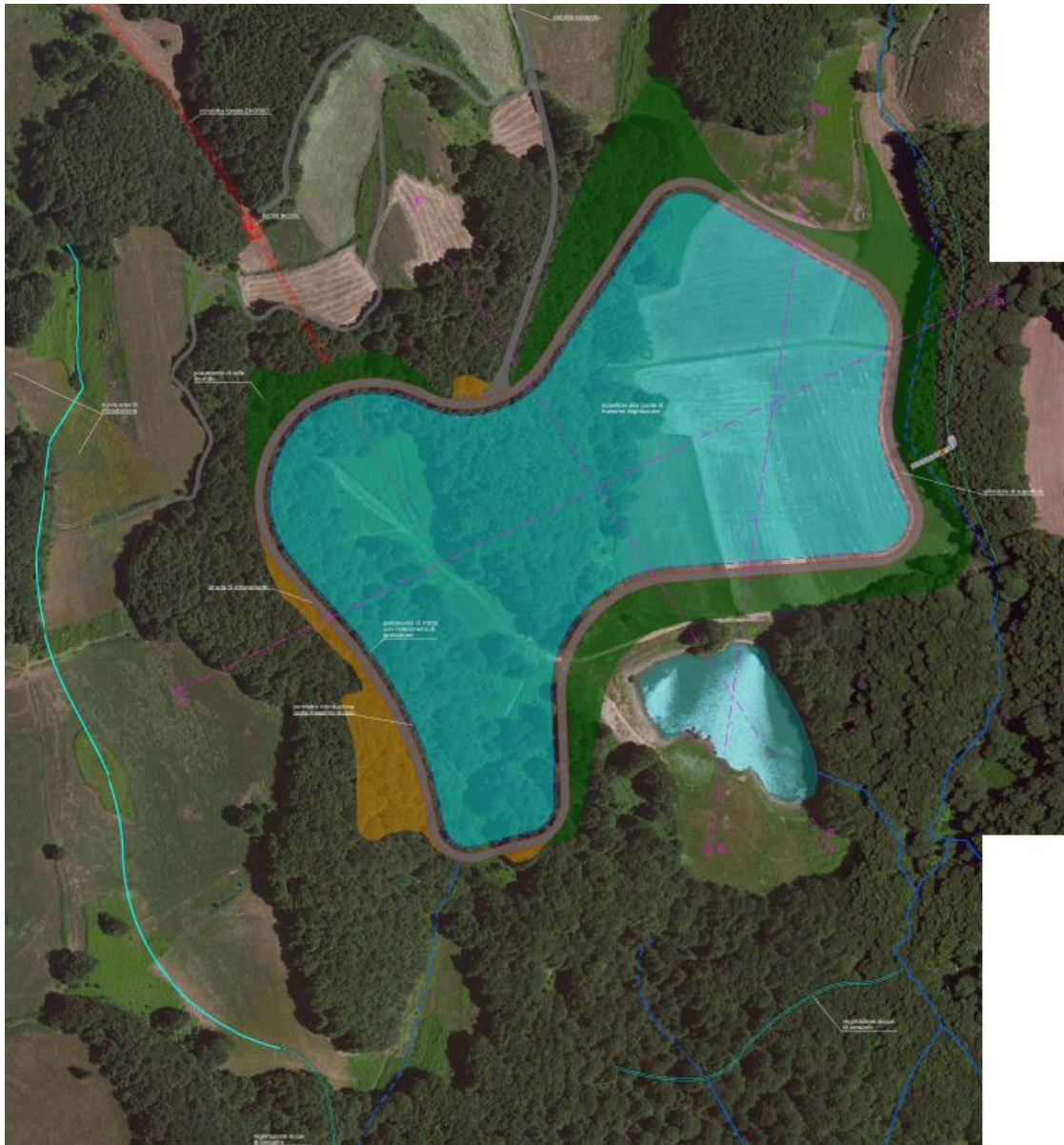
Figura 2. Planimetria di progetto dell'invaso di monte (estratto Tavola PD-EP.17.1).
