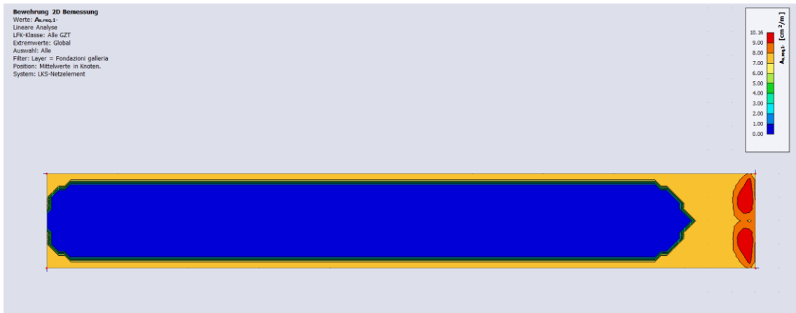
Armatura inferiore in direzione 1.
