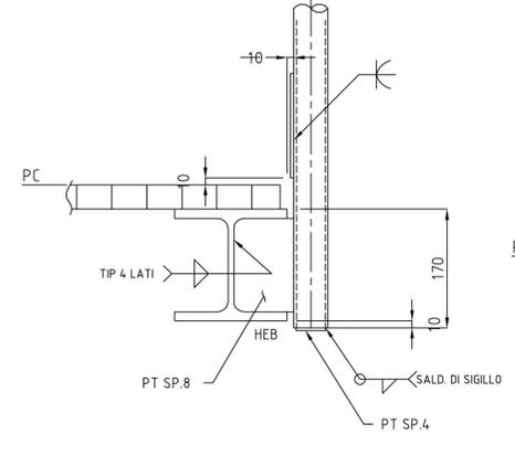
DETTAGLI PARAPETTO FISSO (SCALA 1:5)
