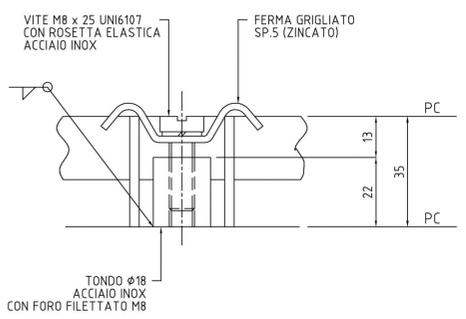
DETTAGLIO FISSAGGIO GRIGLIATO No.4 OGNI PANNELLO DI GRIGLIATO
