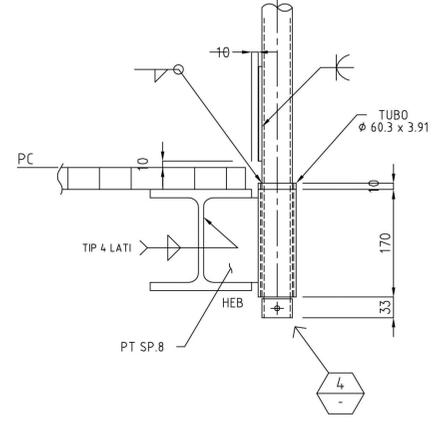
DETTAGLI PARAPETTO REMOVIBILE (SCALA 1:5)
