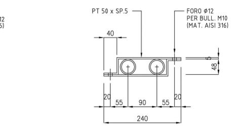
DETTAGLIO CLAMPA PER PARAPETTO REMOVIBILE (SCALA 1:5)
