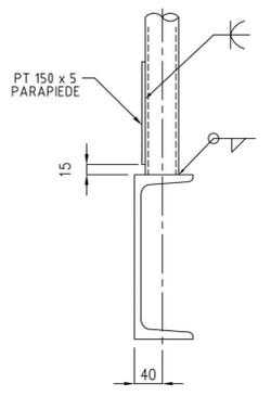
DETTAGLIO PARAPETTO PER SCALE (SCALA 1:5)
