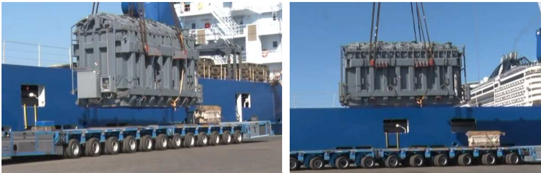
Figura 12. Operazioni di carico e scarico in porto di un trasformatore simile a quello in progetto.
