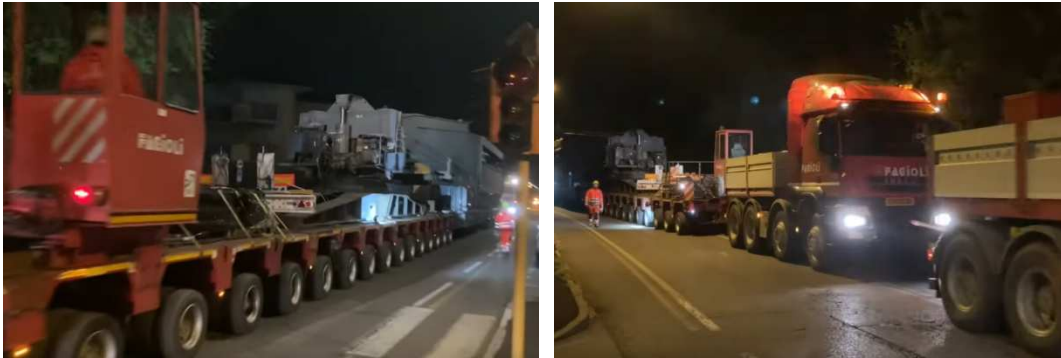
Figura 13. Convoigli speciali per il trasporto di macchinari e trasformatori su gomma.
