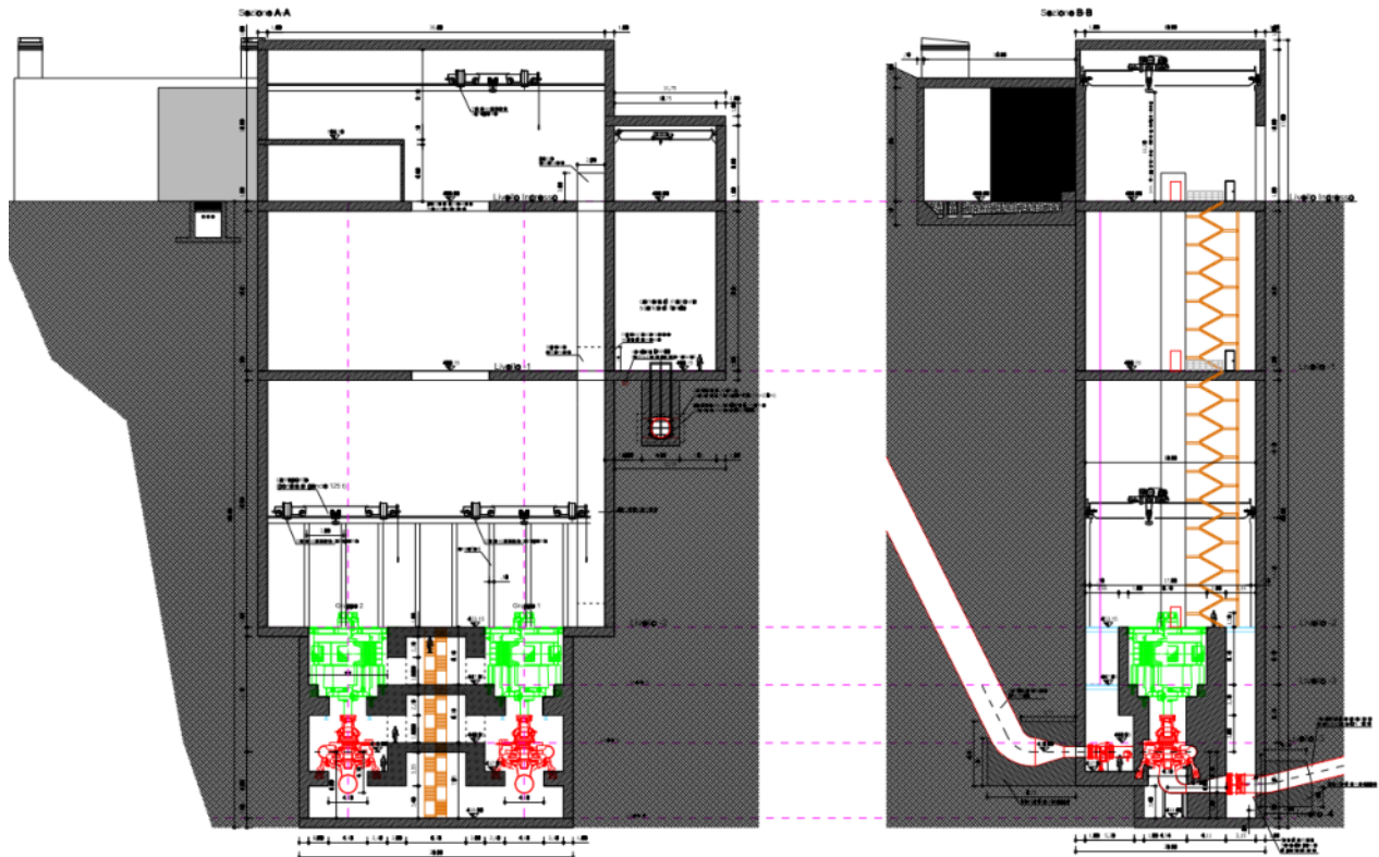
Figura 12: Sezione di progetto della Centrale di produzione/pompaggio
