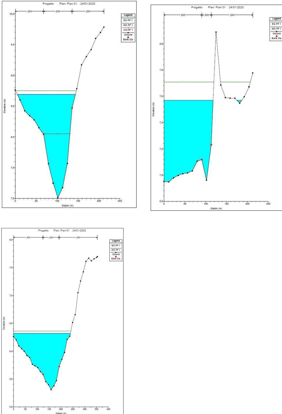
Figure 7- Sezioni con indicazione del livello idrico massimo duecentennale
