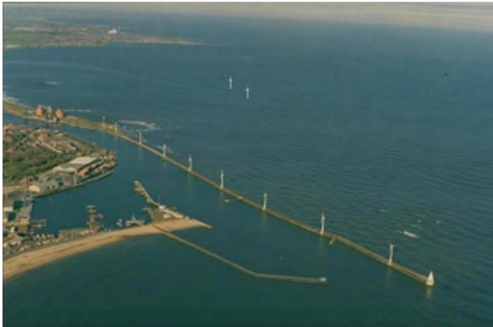
Fig. 11-5a. Impianto scozzese semioffshore ed offshore di Blyth (le due macchine a mare sono dotate di turbine da 2 MW V66)
