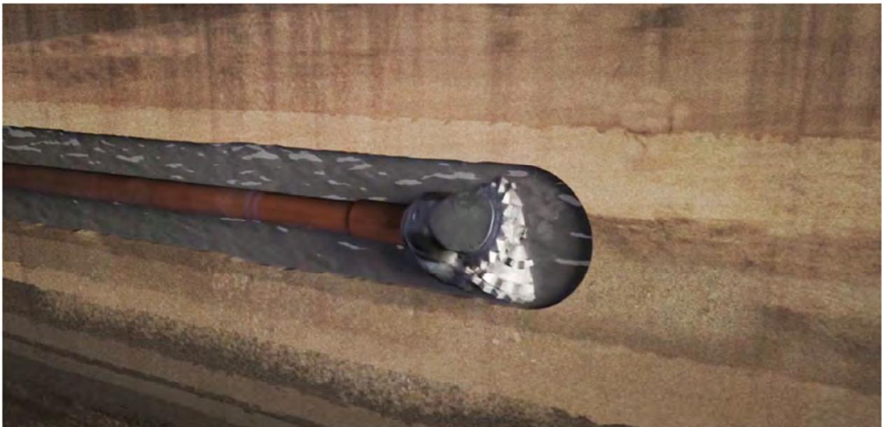
**2) Perforazione pilota (Pilot Bore) di piccolo diametro (100-150 mm) tramite punte a becco d'oca, tricono o turbina ad acqua e bentonite, controllata attraverso il sistema di guida tipo "Para Track", walk-over o MGS.**
