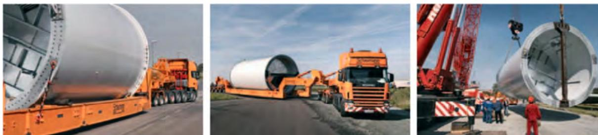
Fig. 7-1n. Movimentazione di parti di torre per turbina 5M (REpower)
