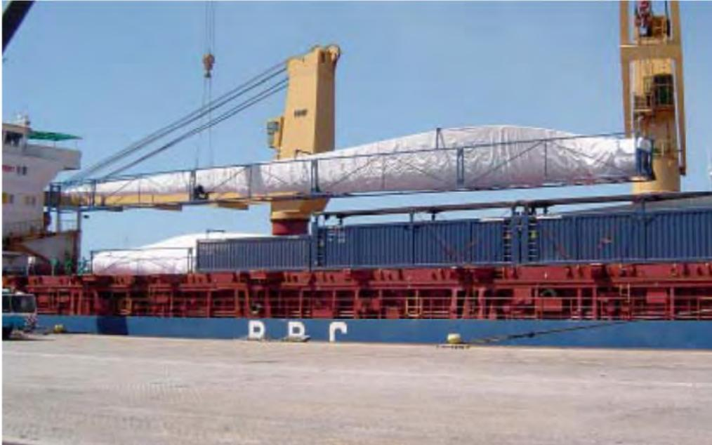
Fig. 3-2f. Movimentazione di pala durante il caricamento su nave (Vestas)
