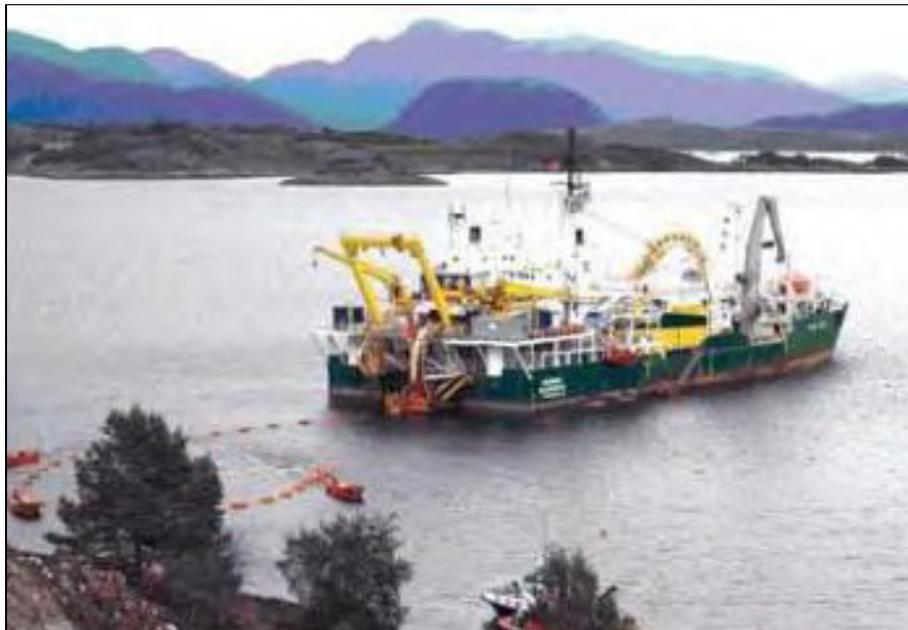
Fig. 7-2f. CS Skagerrak per installare cavi da 420 kV (Nexans)
