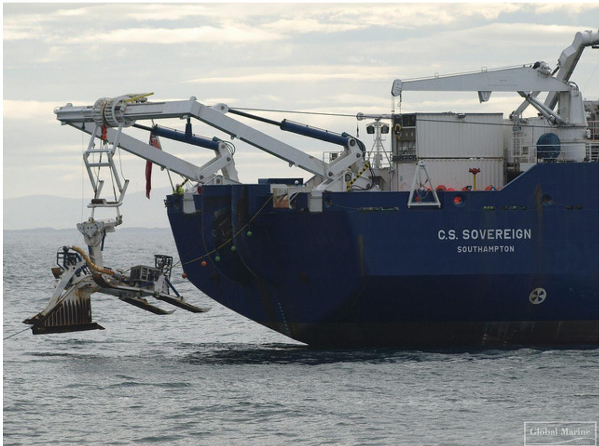
Fig. 8-1r. Nave per il tracciamento di trincea mediante aratro, che è in fase di immersione (C.S. Sovereign)
