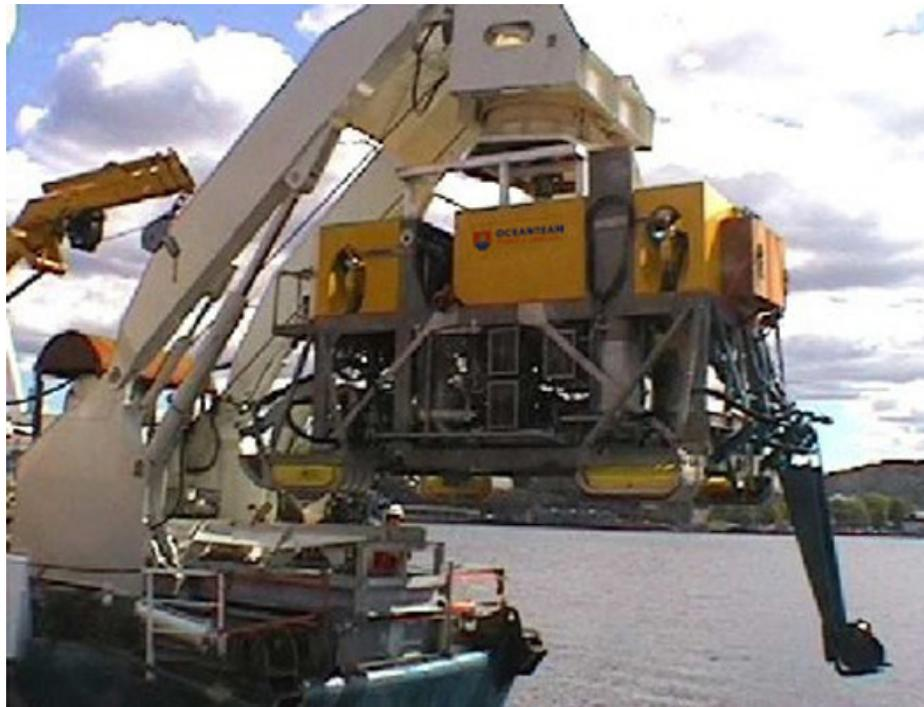
*Fig. 8-2h. Dispositivo a getto d'acqua in fase di immersione (Oceanteam)*
