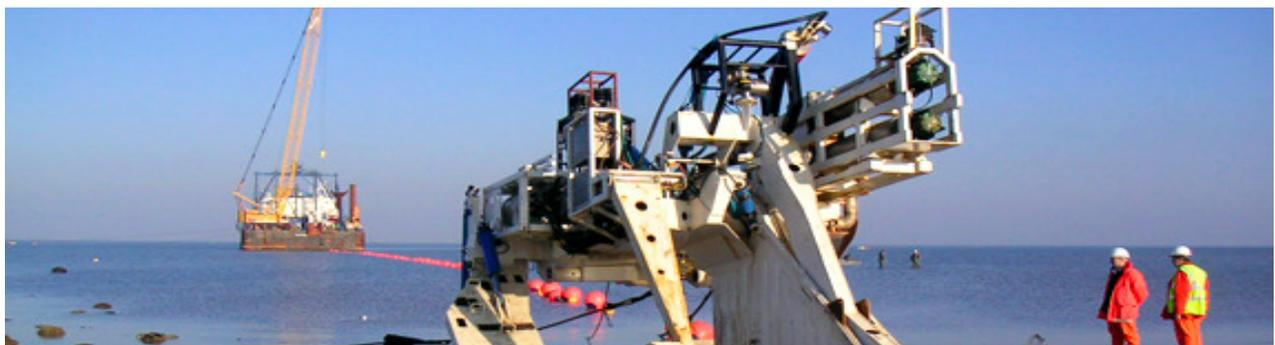
Fig. .8-2t.1. Il trencher Hi plough in azione
