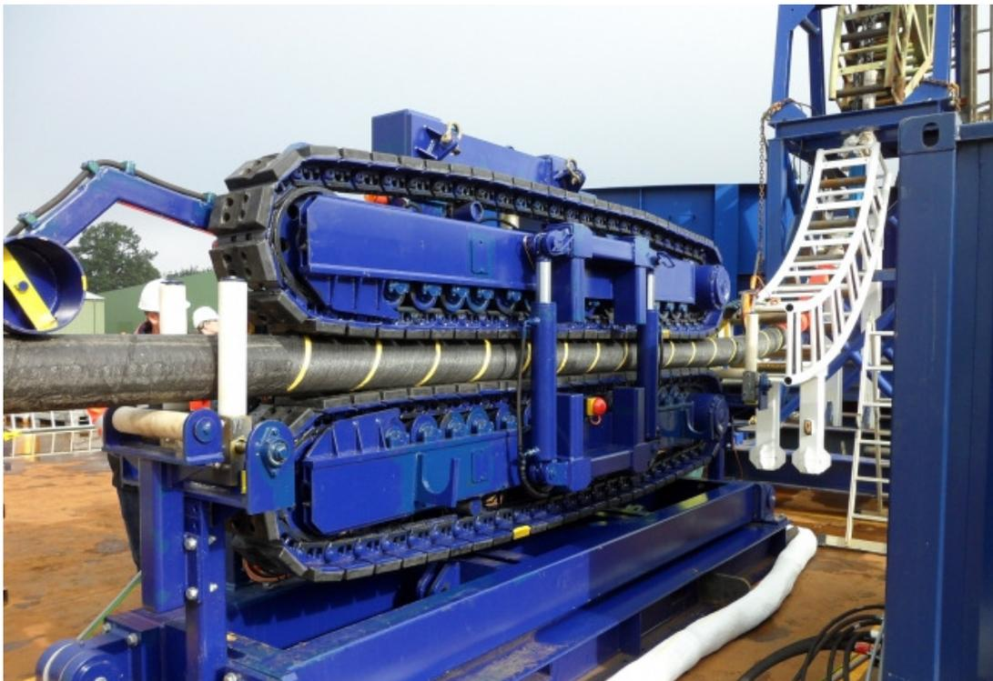
Fig. 8-2k.1. Dispositivo traente da 10/15 ton per cavi sottomarini o ombelicali (4 C Offshore)
