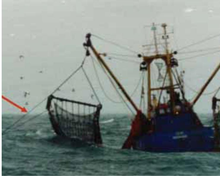
*Fig. 7-1a.2. Rete a strascico in emersione con agganciato un cavo sottomarino per telecomunicazioni (Tyco Telecommunications Inc., USA)*
