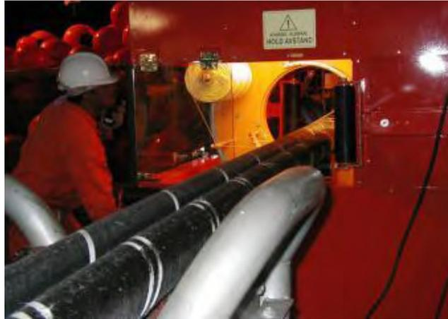
*Fig. 8-1g. Affastellamento (bundling) dei cavi durante il rilascio per la posa (Global Marine Systems Ltd)*
