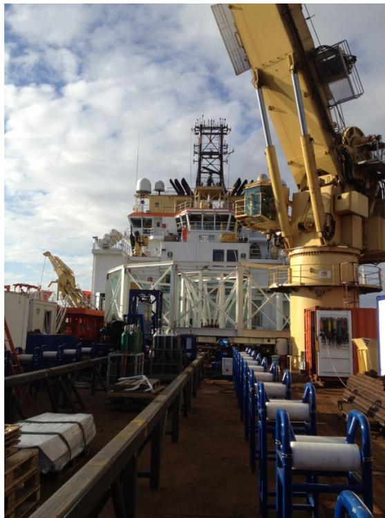
Fig. 8-2k.2. Via di guida del cavo (Oceanteam)
