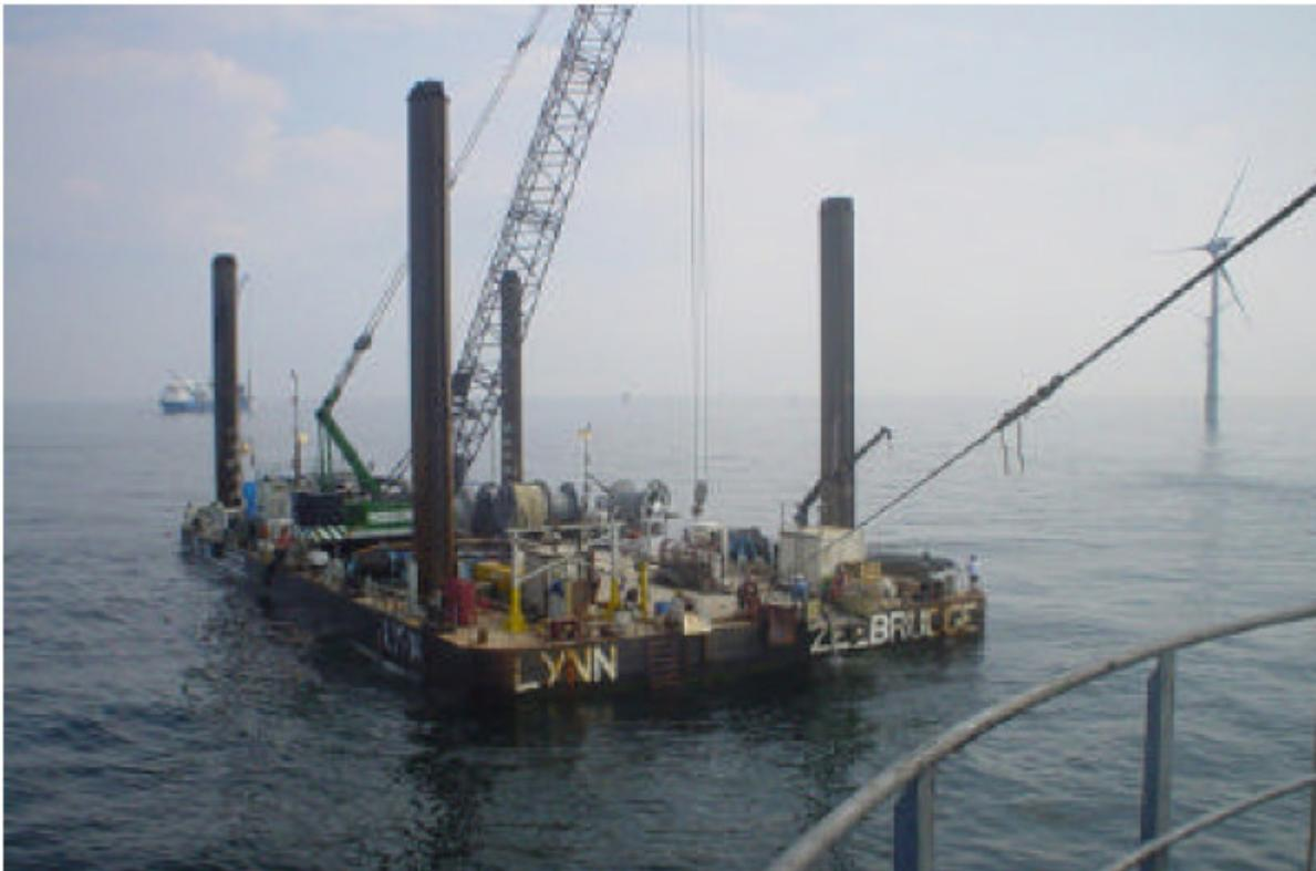
*Fig.8-2n. Mezzo navale impiegato per la posa dei cavi sottomarini del campo eolico di Horns Rev (Lynn)*
