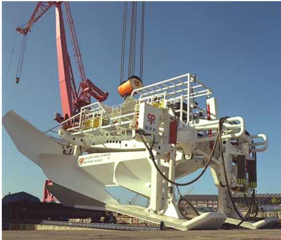
*Fig. 8-2i. Dispositivo per scavo mediante azione meccanica di aratura (Nuggets)*
