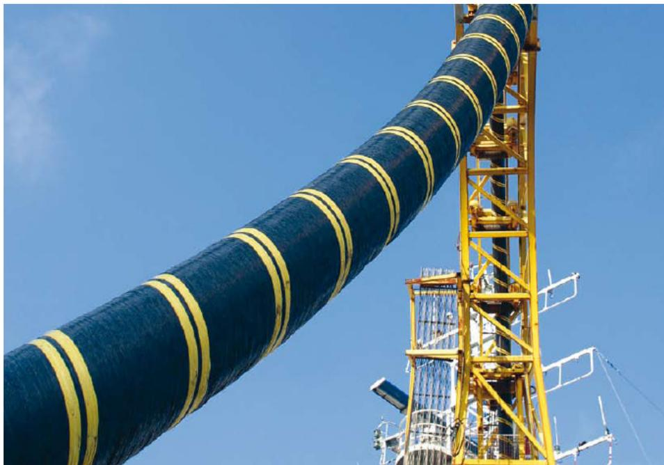
*Fig. 7-2b. Cavo sottomarino per alti voltaggi (Reportlinker)*
