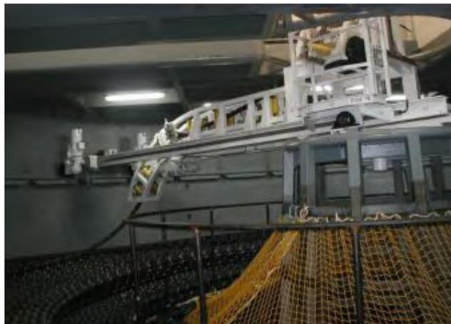
Fig. 8-1f. Braccio di carico/scarico del cavo (Global Marine Systems Ltd)
