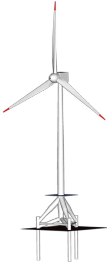
*Fig. 4-3b. Schema di turbina 5M su treppiede di tipo simile a quello del prototipo di Brunsbüttel (REpower)*
