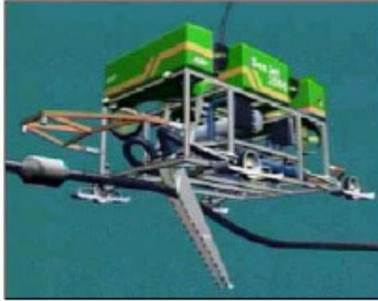
*Fig. 8-2g. Dispositivo a getto d'acqua tipo SeaJet per il posizionamento meccanico di cavi e tubi (Ballast Ham Dredging Co.)*
