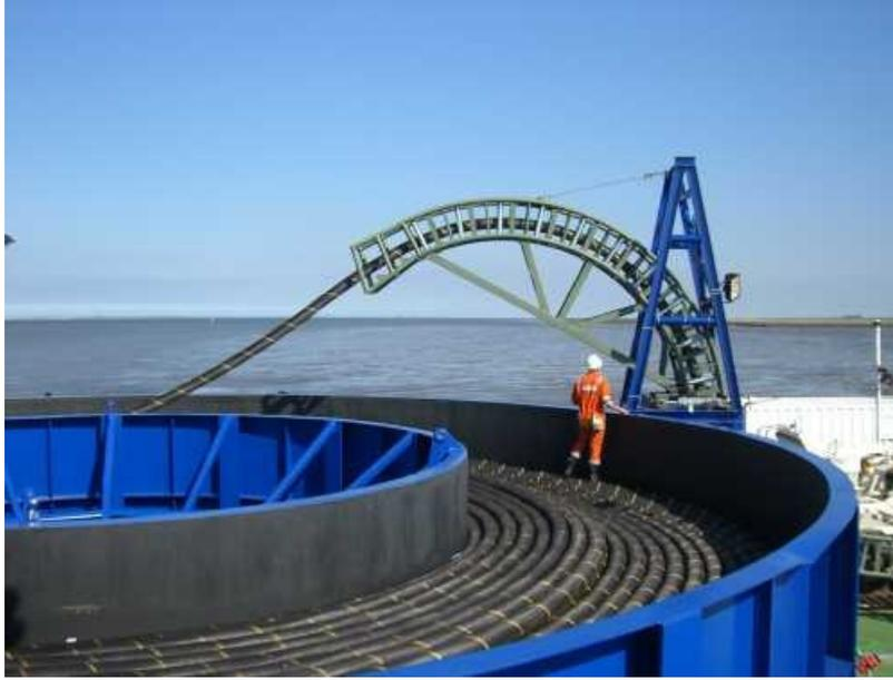
Fig. 8-1i. Tamburo da 750 ton per cavo sottomarino (Carousel)
