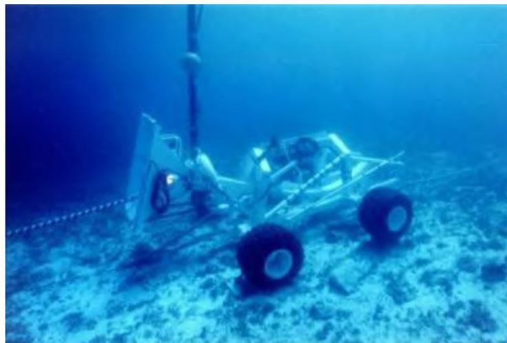
Fig. 8-1u.3. ROV Hydroplow adatto a compiti installativi del cavo (Center Marine)
