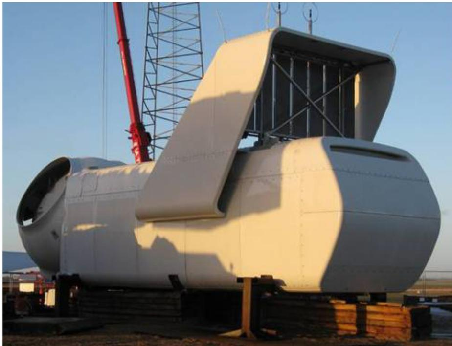
*Fig. 5-1q. Completamento della navicella con mozzo e sistema di raffreddamento, collocato sul cielo dell'unità (Vestas)*
