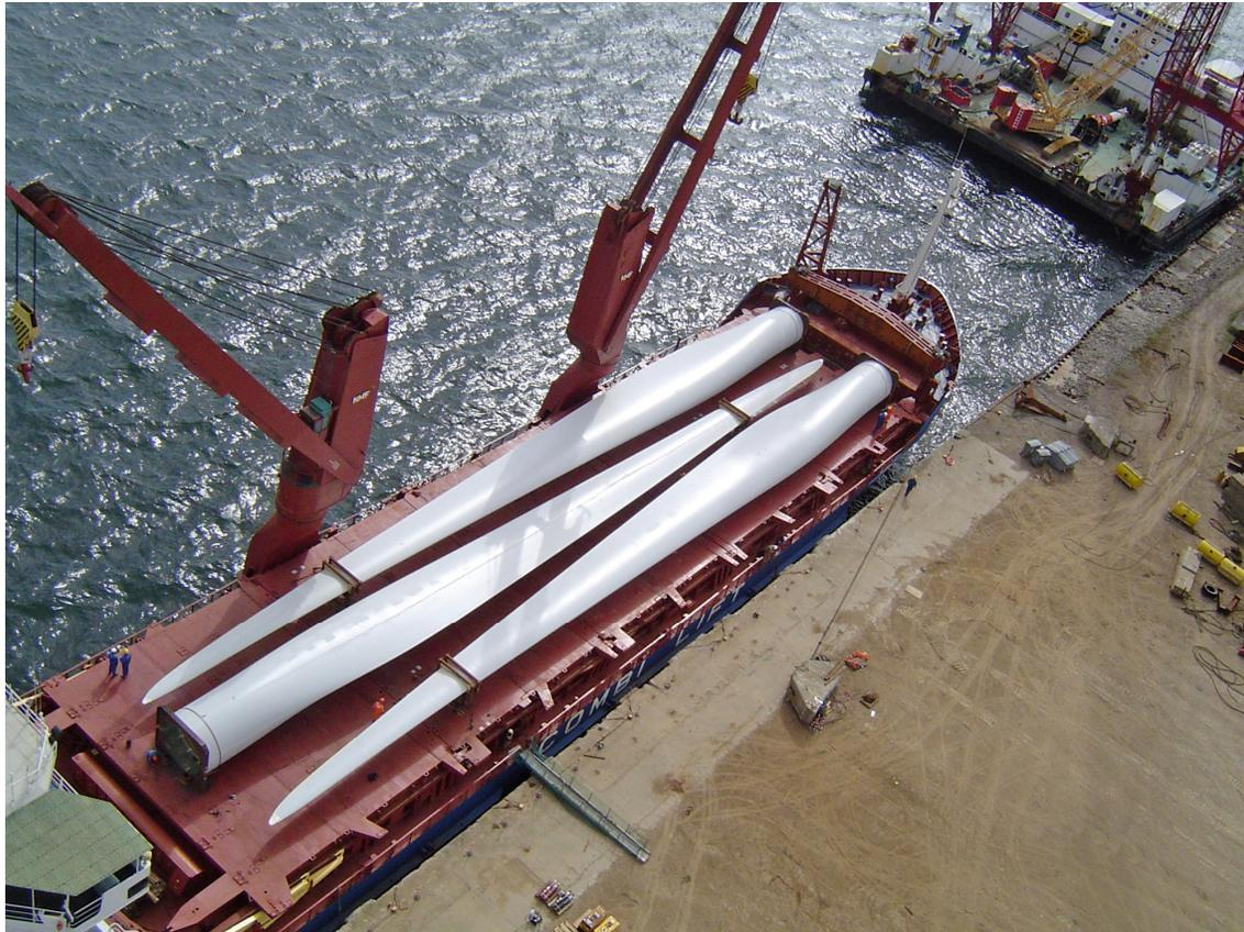
*Fig. 8-1e. Trasporto di pale per aerogeneratore 5M da sistemare nel campo di Moray Firth in Scozia (REpower)*
