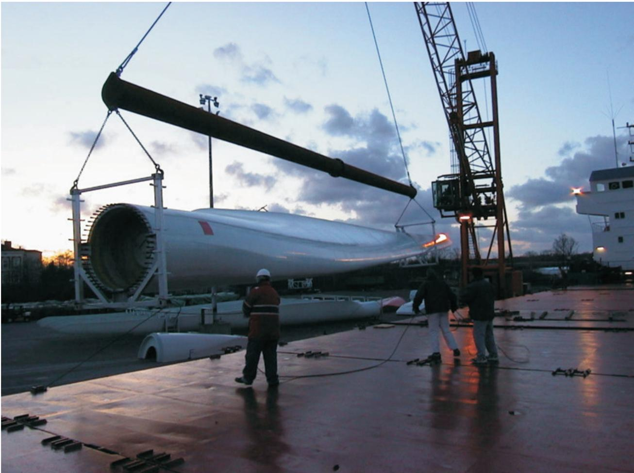
*Fig. 8-1b. Movimentazione di pala per aerogeneratore 5M (REpower)*
