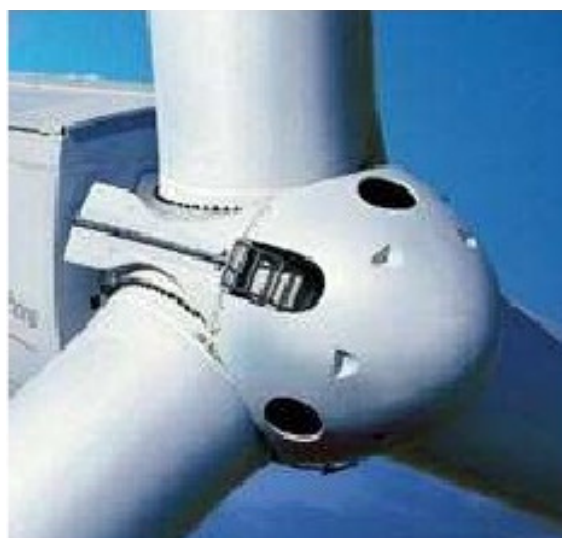
Fig. 6-1d. Mozzo (1, 2 e 3), naso (o cover, 5) e connessione pala mozzo in fase di attuazione (4)
