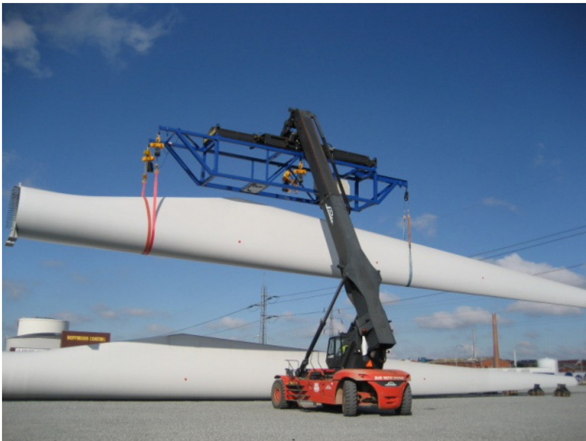
Fig. 6-2a. Trasporto mediante gru gommata di pala per unità V112 (Vestas)
