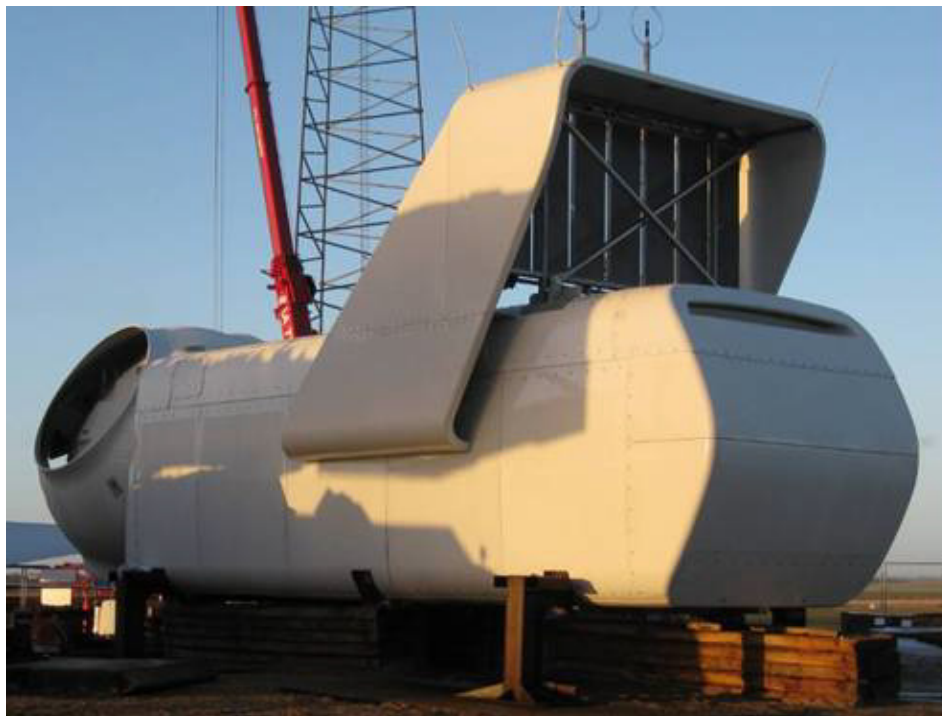
Fig. 6-2c. Navicella per turbina V112 completa del mozzo e del sistema di raffreddamento (Vestas)
