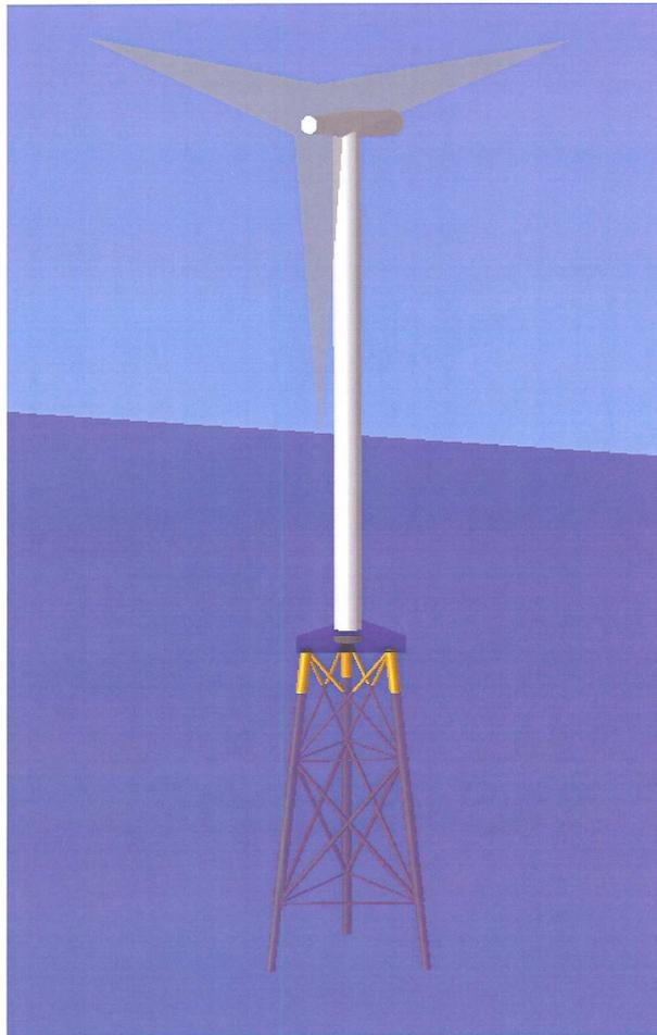
*Fig. B-1 Schema di struttura fondaria a tre montanti.*
