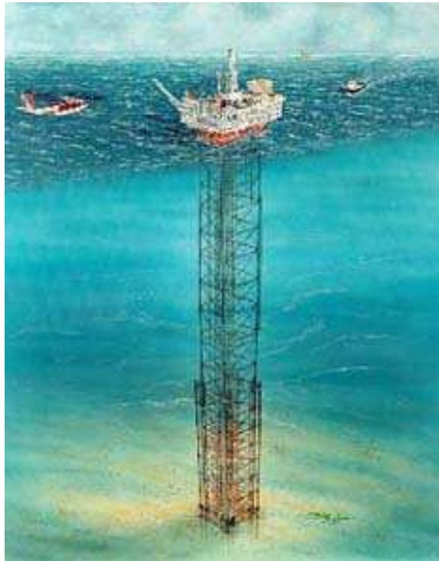
Fig. A-3a. Sketch di traliccio (di tipo cedevole) in fondali non bassi per piattaforma petrolifera
