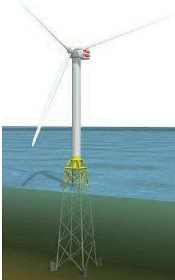
*Fig. B-2d. Schema di struttura portante con i tubi di guida dei pali di fondazione fissati al piede dei montanti*
